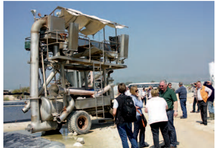
Abb. 10: Fischpumpen zum Abfischen und Sortieren von Fischen sind sehr verbreitet
