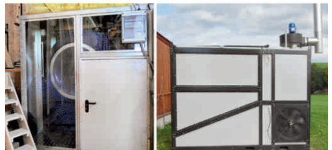
Abb. 18: Links Kompaktanlage mit Entfeuchter; rechts Warmluftöfen.
