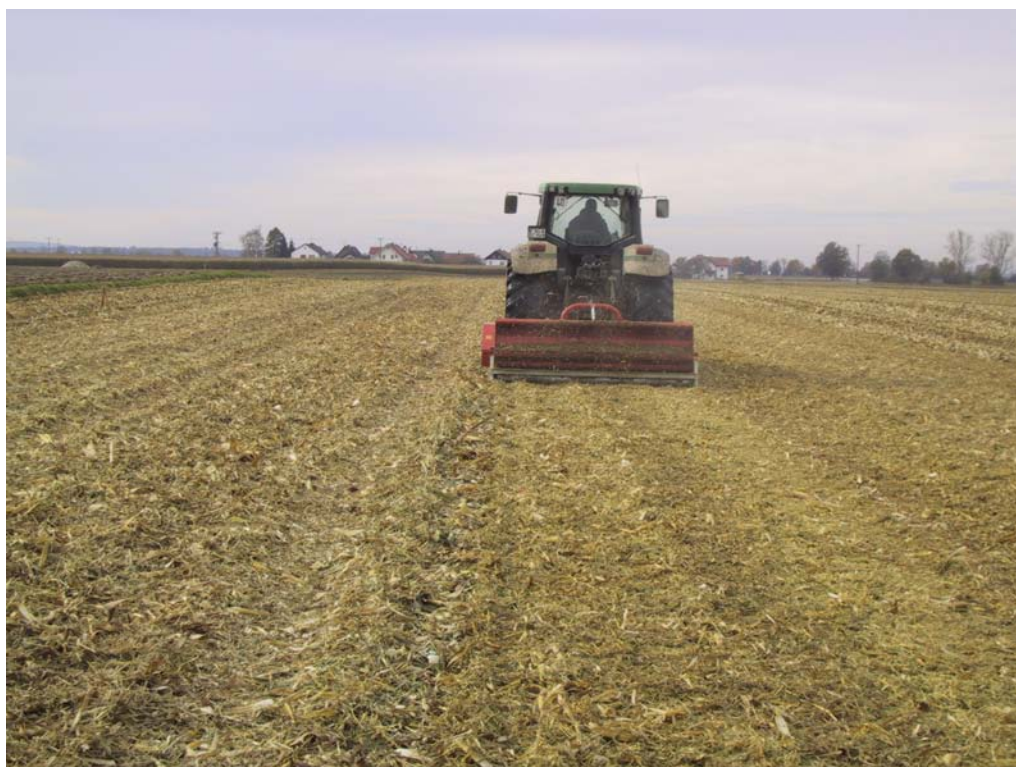
Abbildung 9: Einsatz Kuhn Mulchgerät (Typ BNG)
