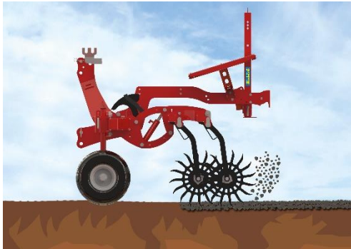
Abbildung 9: Rollhacke in der Seitenansicht (Grafik: Firma Einböck)
