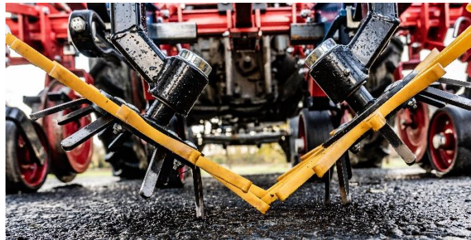
Abbildung 19: Die Fingersterne (gelb) werden durch die darunterliegenden Metallkränze über den Boden angetrieben. (Foto: Johannes Siebigteroth, Universität Bonn)
