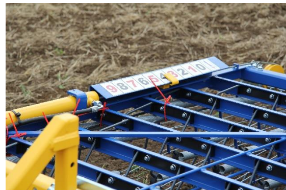
Abbildung 12: Präzisionsstriegel der Firma Treffler Maschinenbau mit Skala der Zinkenvorspannung von 0 bis 9, hier eingestellt auf den Skalenwert 4 (gelber Zeiger). Einige äußere Zinken sind mit roten Kabelbindern am Rahmen fixiert, um sie außer Betrieb zu setzen (Foto: Andrea Baron)
