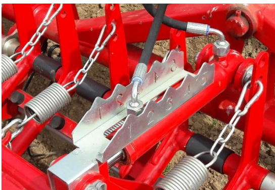
Abbildung 17: Hydraulische stufenlose Einstellung des Zinkendrucks in 5 Stufen beim Einböck-Rollstriegel (Foto: Matthias Bernschein)
