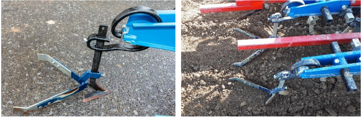
Abbildung 20: Flachhäufelschar an einem Gänsefußschar montiert für leichtes Anhäufeln bei geringer Kulturhöhe. Links: Anbau am Gerät (Foto: Johannes Siebigteroth, Universität Bonn). Rechts: Wirkung im Boden (Foto: Matthias Bernschein)
