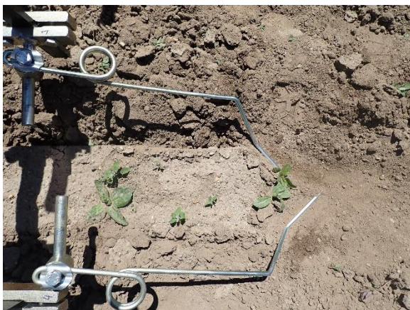
Abbildung 22: Federstab-Hackelemente einer Torsionshacke: Eingriff in den Boden (links), rechts: Fixieren und Einstellen der Neigung der Zinken mittels Schraube am Rundstab (Fotos: Andrea Baron)
