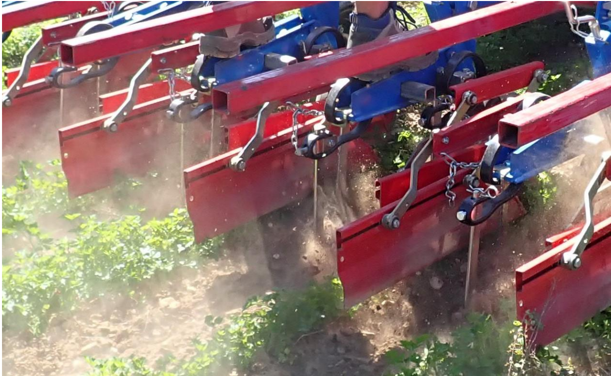
Abbildung 28: Häufelschare im Einsatz in 10 bis 12 cm hoher Petersilie; die Schutzbleche sind angehoben, um die Blätter nicht zu beschädigen (Foto: Christine Kolm).
