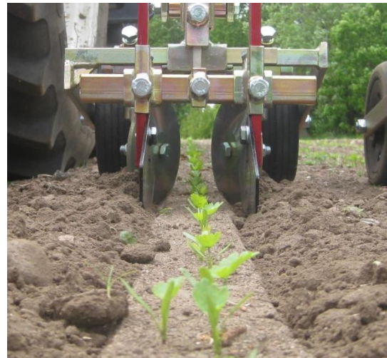
Abbildung 7: Schutzscheiben an einer Scharhacke schützen kleine Kulturpflanzen vor dem Verschütten. (Foto: Firma K.U.L.T. Kress Umweltschonende Landtechnik)
