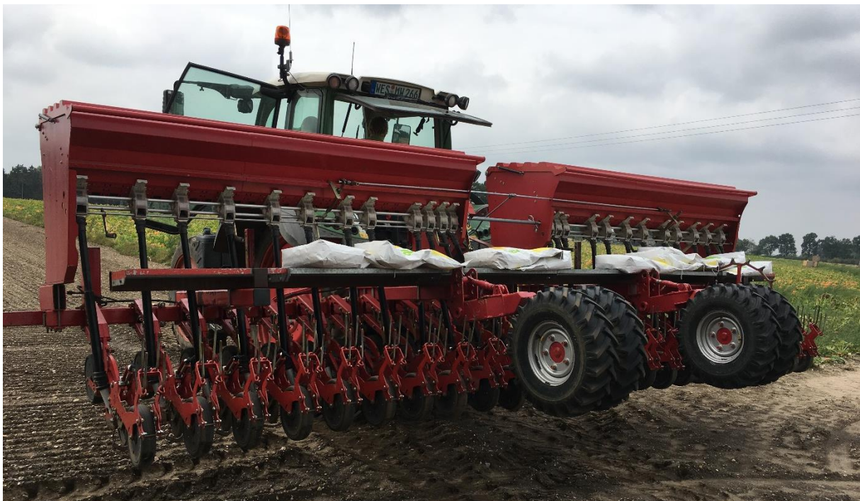
Abbildung 4: Drillmaschine mit tandemgeführten Säaggregaten zur Aussaat ohne Bodenbearbeitung in das abgesetzte Saatbett (Foto: Hans Jörg Kornik)
