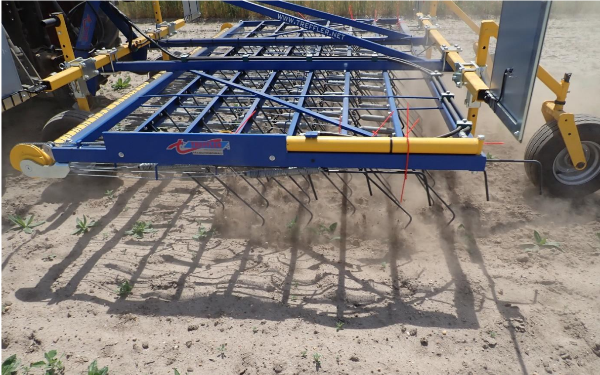
Abbildung 13: Präzisionsstriegel im Einsatz. Montiert sind „Kombifedern“ und Zinken mit einem Kröpfwinkel von 105°. Die äußeren Zinken sind zur Verringerung der Arbeitsbreite am Rahmen fixiert und damit außer Betrieb. (Foto: Christine Kolm)
