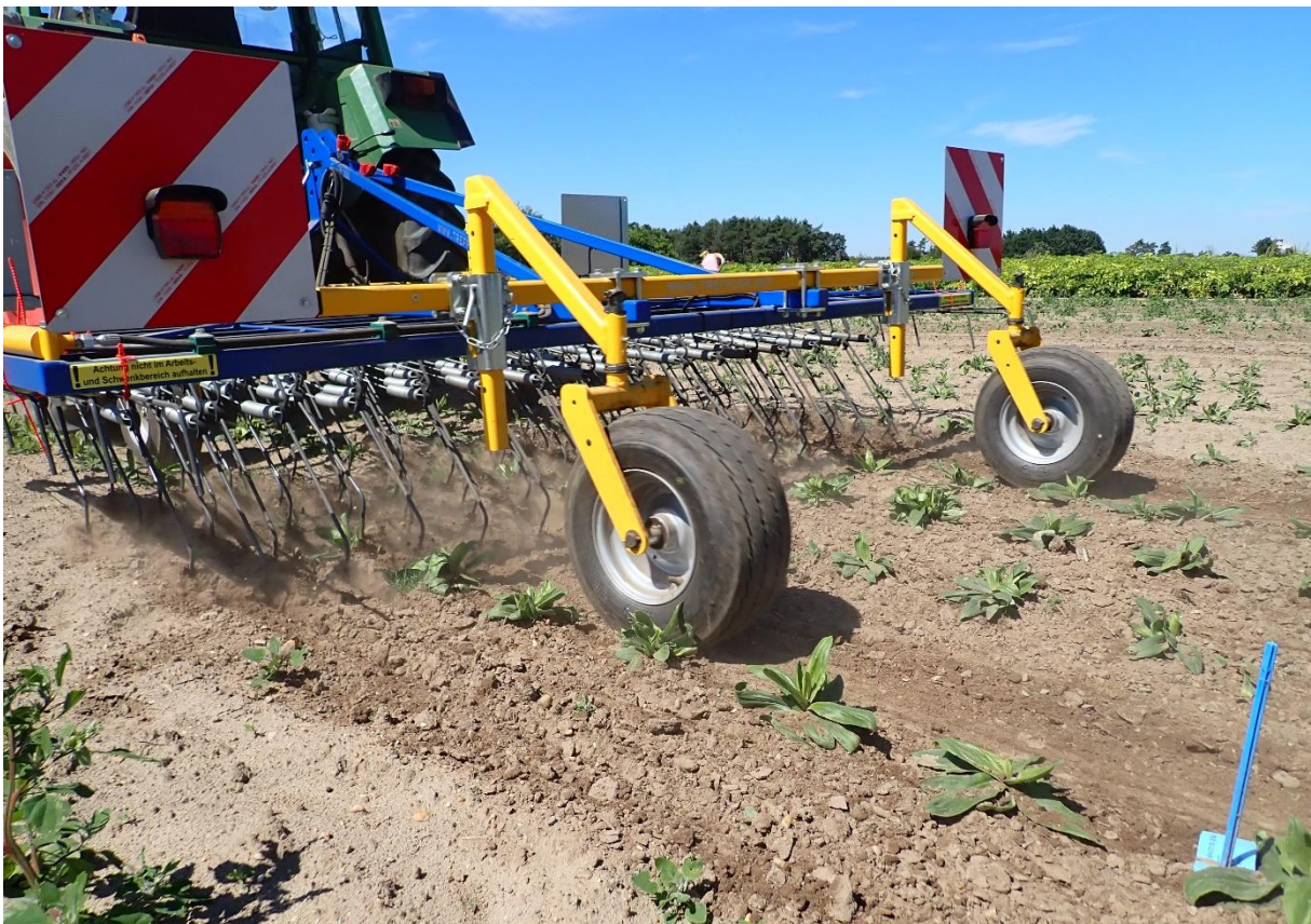
Abbildung 14: Pendelstützräder im Heck stabilisieren zusätzlich die Höhenführung des Präzisionsstriegels über dem Boden. (Foto: Christine Kolm)
