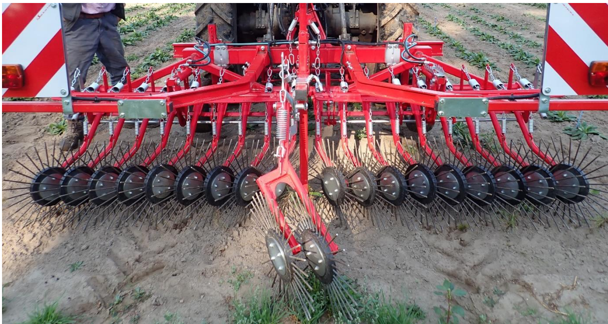
Abbildung 15: Rollstriegel (Einböck) mit 3 m Arbeitsbreite für Versuchspartzen (Foto: Andrea Baron)
