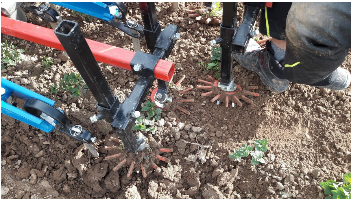
Abbildung 45: Einsatz der Fingerhacke mit mittelgroßen, harten Fingerelementen in Pfefferminze am Campus Klein-Altendorf 2020, 57 Tage nach Pflanzung (Foto: Matthias Bernschein)
