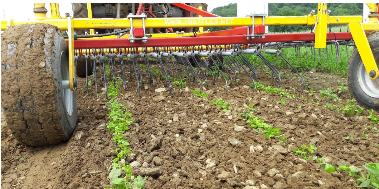
Abbildung 27: Den Einsatz des Präzisionsstriegels am Campus Wiesengut (2021) hat die Petersilie bei einer Kulturhöhe von 5 cm (BBCH 13), Fahrgeschwindigkeit = 2 km/h, Arbeitstiefe = 2 cm gut vertragen (Foto: Charlotte Junker)
