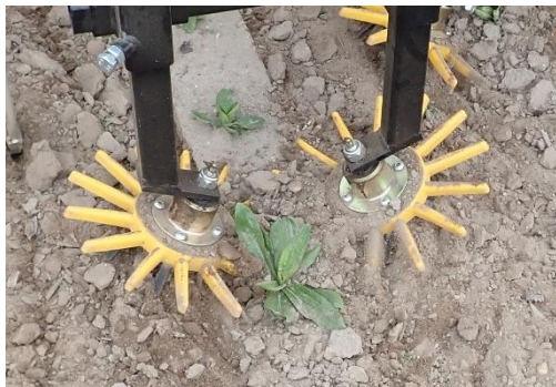
Abbildung 18: Fingerhackelemente bei der Unkrautregulierung im Bereich der Arnika-Pflanzenreihe in Kombination mit einer Scharhacke (Foto: Andrea Baron)
