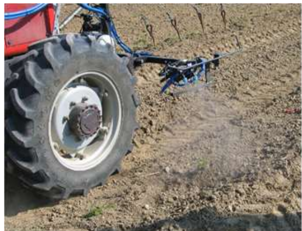
Sensorgesteuerte Flachstrahldüsen zur Reihenbehandlung
