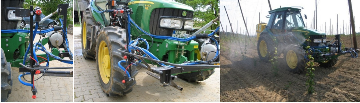
Abb + : Sensorgesteuerte Applikationstechnik zum 2. Anwendungszeitpunkt (02.05.2011) bis 1,5 m Wuchshöhe
