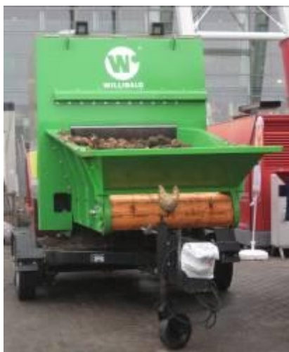
Abbildung 11: Willibald-Schredder mit hoher Durchsatzleistung und „Steintoleranz“
