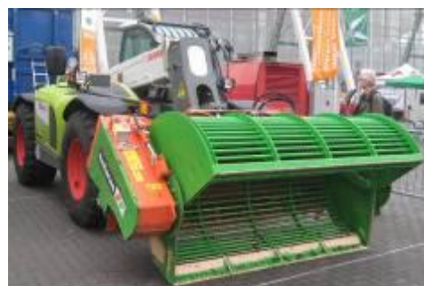
Abbildung 10: Rübenwasch- und -schneidschaufel von Holaras (ohne Stein-trennung)
