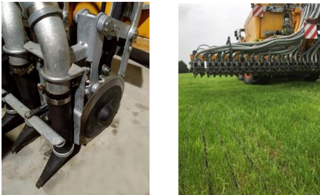
Abb. 9: Bei der Gülleinjektion werden mit einer Schneidscheibe Grasnarbe und Boden aufgeschnitten und nachfolgend die Gülle in den entstandenen Schlitz abgelegt. Das linke Bild zeigt das Prinzip der Technik, das rechte Bild das Ergebnis im Bestand.
