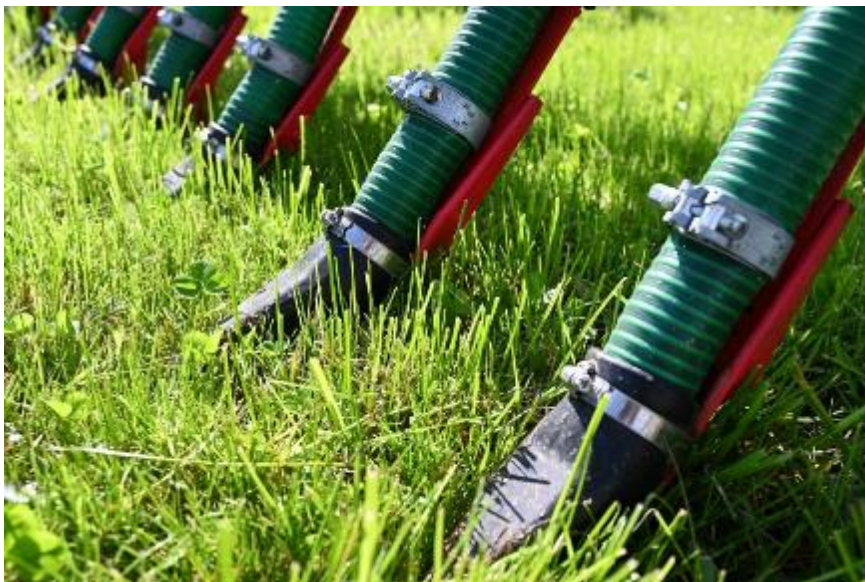
Abb. 5: Ziel beim Schleppschuh: Scheitern des Pflanzenbestands und Ablage des flüssigen Wirtschaftsdüngers auf den Boden bzw. in den durch die Kufen leicht angeritzten Boden.
