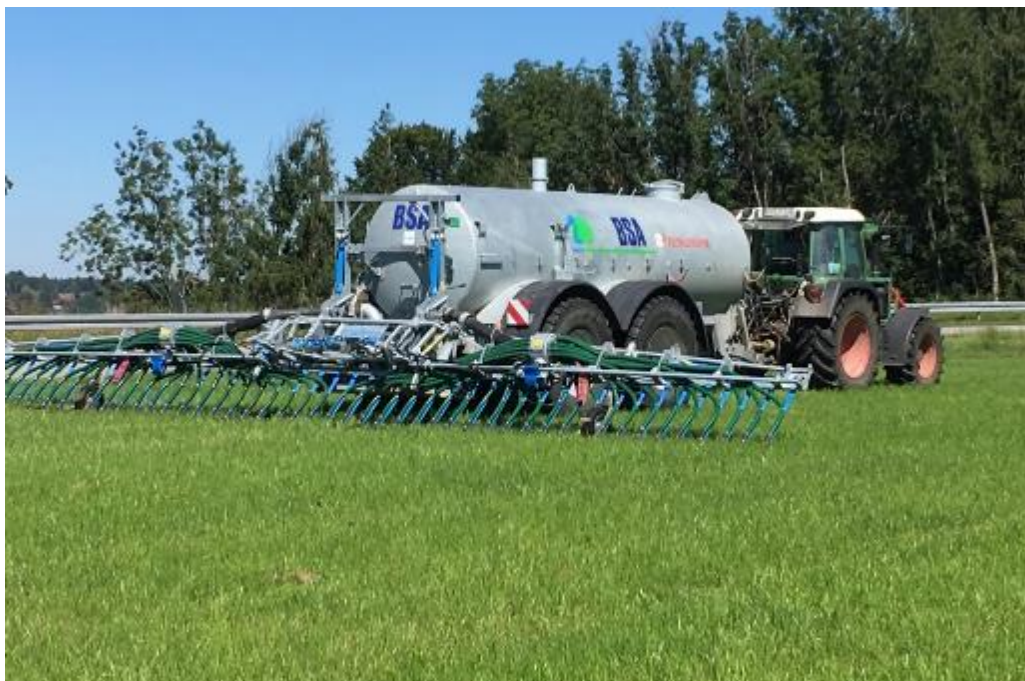
Abb. 1: Bodennahe streifenförmige Ausbringverfahren (hier Schleppschuh) von flüssigen Wirtschaftsdüngern sind für die notwendige Minderung der Ammoniakemissionen aus der Landwirtschaft unverzichtbar!
