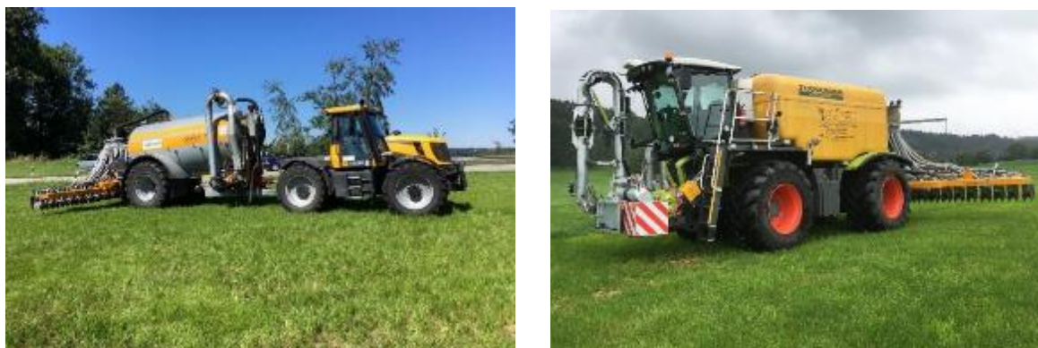
Abb. 11: Die Injektionstechnik (links gezogenes Fass, rechts Selbstfahrer) hat die niedrigsten Ammoniakverluste unter den bodennahen streifenförmigen Techniken.
