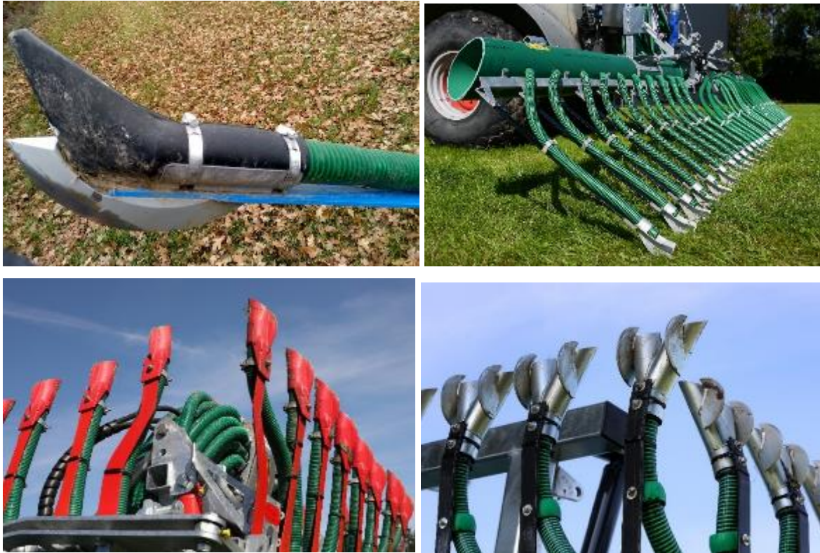
Abb. 4: Schleppschuhtechnik ist im Detail unterschiedlich. Hier sind als Beispiel verschiedene Systeme dargestellt, die sich z.B. in der Ausprägung der Kufen deutlich unterscheiden und damit teilweise auch deutlich im Verteilbild.
