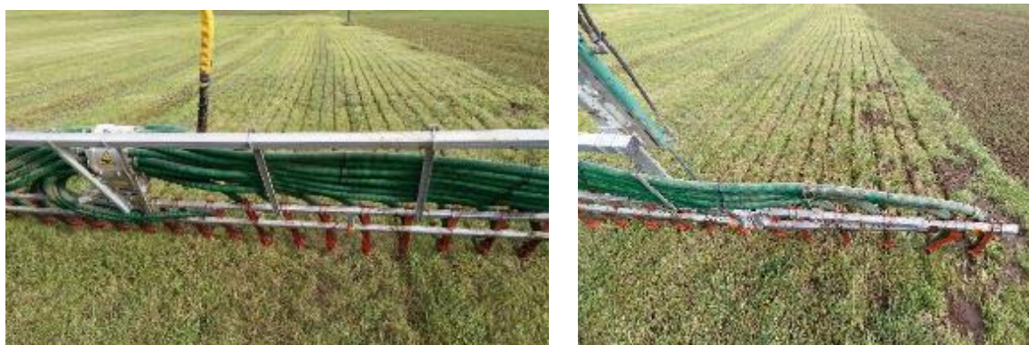
Abb. 15: Im Prinzip ist hier die Gülle sauber mit dem Schleppschuh unter den Bestand abgelegt (Bild links). Was aber ein Problem bei der Ernte und Konservierung sein kann, sind offene Bodenstellen (Bild rechts). Werden die Mäh- und Erntegeräte nicht genau darauf eingestellt und gelangt Boden in das Futter, kommen damit auch Clostridien ins Futter und die Gefahr einer nicht optimalen Silage ist gegeben.
