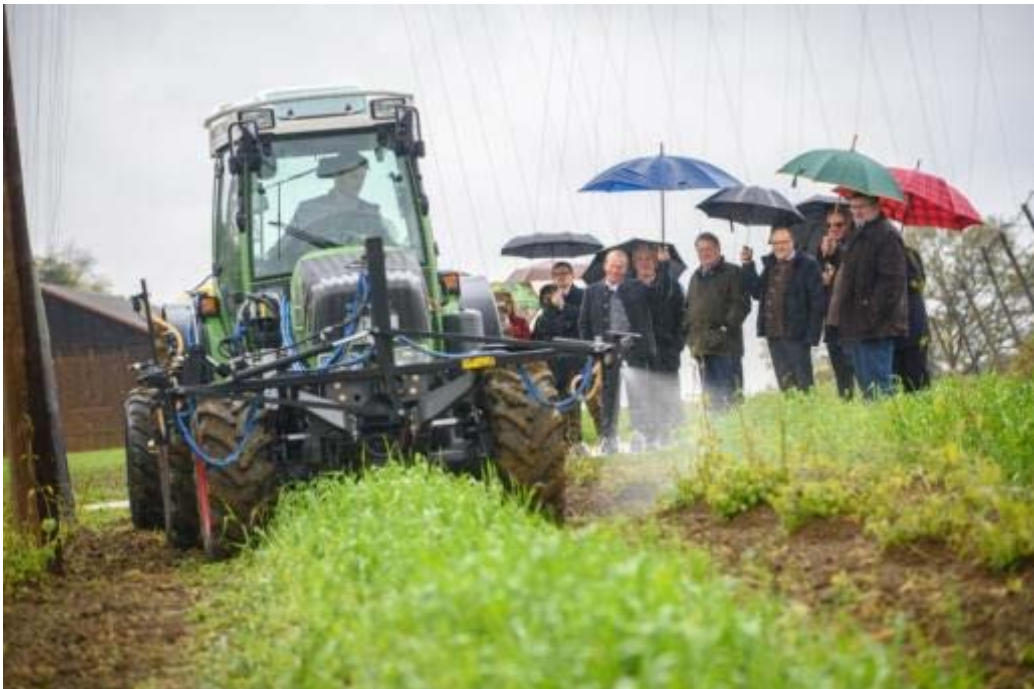
Abb. 5.4: Demonstration des sensorgesteuerten Pflanzenschutzgerätes zur Reihenbehandlung im Hopfen
