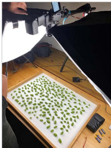
Abb. 4.14: Aufbau zur Fotografie der Hopfendolden
