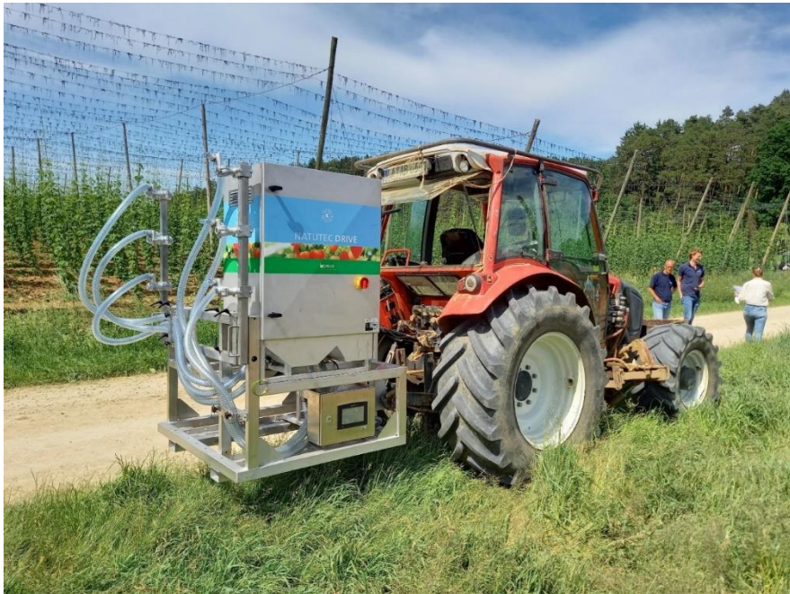
Abb. 8.4: Neuartige Konstruktion der Fa. Koppert (‚Natutec‘) zur technischen Ausbringung von Raubmilben im Hopfenbestand; Dürnwind. im Juni 2021
