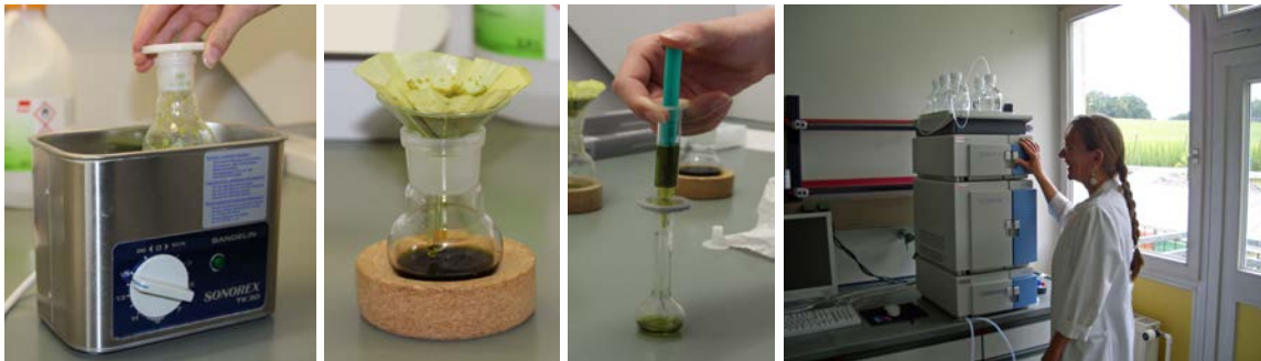
Abb. 7.16: Probenvorbereitung und HPLC-Analyse der Multifidole
