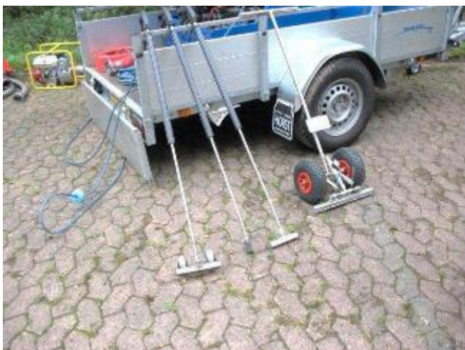
Abb. 9: Bei Heißwassergeräten wird das Unkraut mit 98° C heißem Wasser benetzt. Dabei gerinnt das Pflanzeneiweiß und die Pflanzen sterben ab. Die Abbildung zeigt verschiedene Handlanzen mit unterschiedlichen Arbeitsbreiten.
