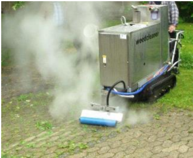
Abb. 8: Hochdruck-Heißdampfgeräte erzeugen Wasserdampf. Das Unkraut stirbt durch die Dampfeinwirkung ab. Auf der Bodenoberfläche liegende Samen keimen nach dieser Behandlung meist nicht mehr.
