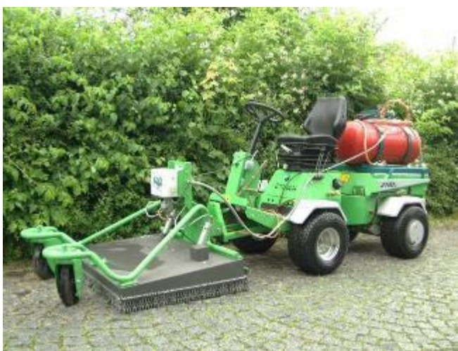
Abb. 12: Abflamngeräte bringen die Pflanzen zum Absterben. Dabei müssen die Pflanzen nicht einmal vollständig abgeflammt werden. Zudem erhöht ein vollständiges Abflammen unnötigerweise die Kosten und die Brandgefahr.
