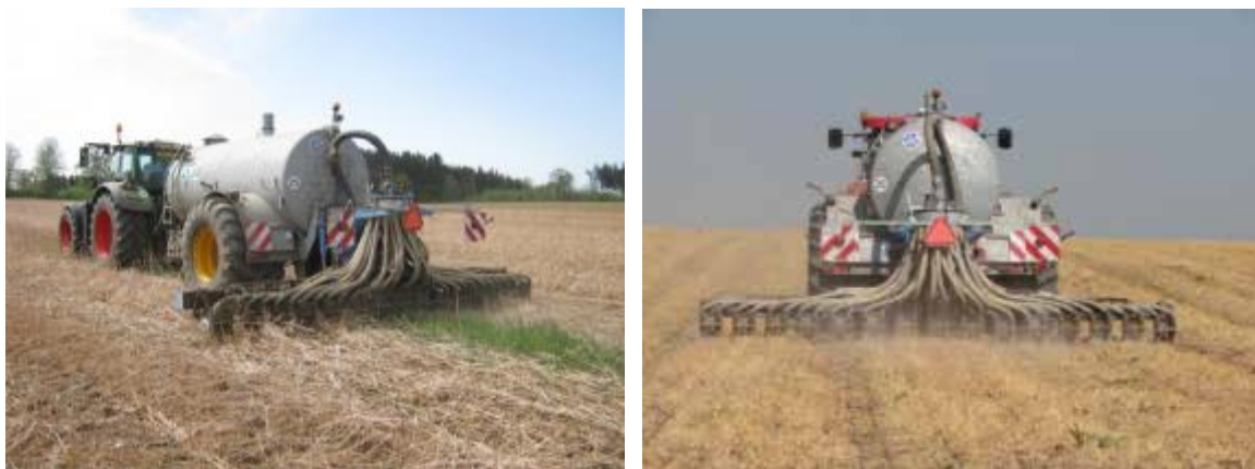
Abb. 11: Flächige Ausbringung von flüssigem Wirtschaftsdünger in abgefrorene Zwischenfruchtbestände mit einem Scheibenschlitzverteiler
