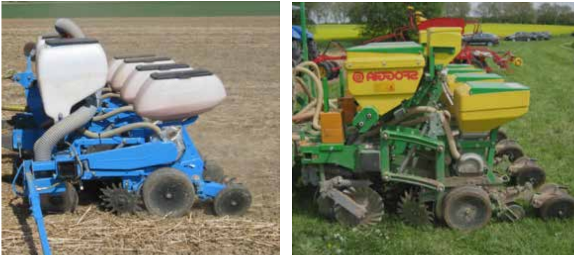
Abb. 14: Räumsterne bzw. Kombination aus (gewelltem) Scheibensech und Räumsternen für verbesserte Ablage und Einbettung bei Mulch- und Direktsaat.
