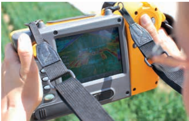
Abb. 4: Thermografische Erfassung von Stress durch Trockenheit im Rain-out-shelter
