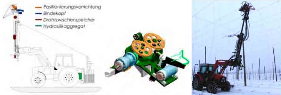
Optimierte Teilsysteme (links); Optimierter virtueller Prototyp (Mitte); Prototyp beim Aufhängen von Aufleitdrähten in einem Hopfengarten (rechts)
