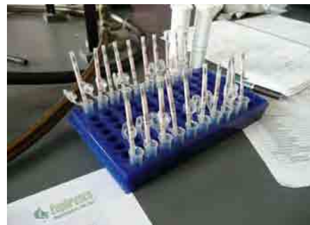
„ImmunoStrip® Test“ zum schnellen Nachweis von Cms und Rs
