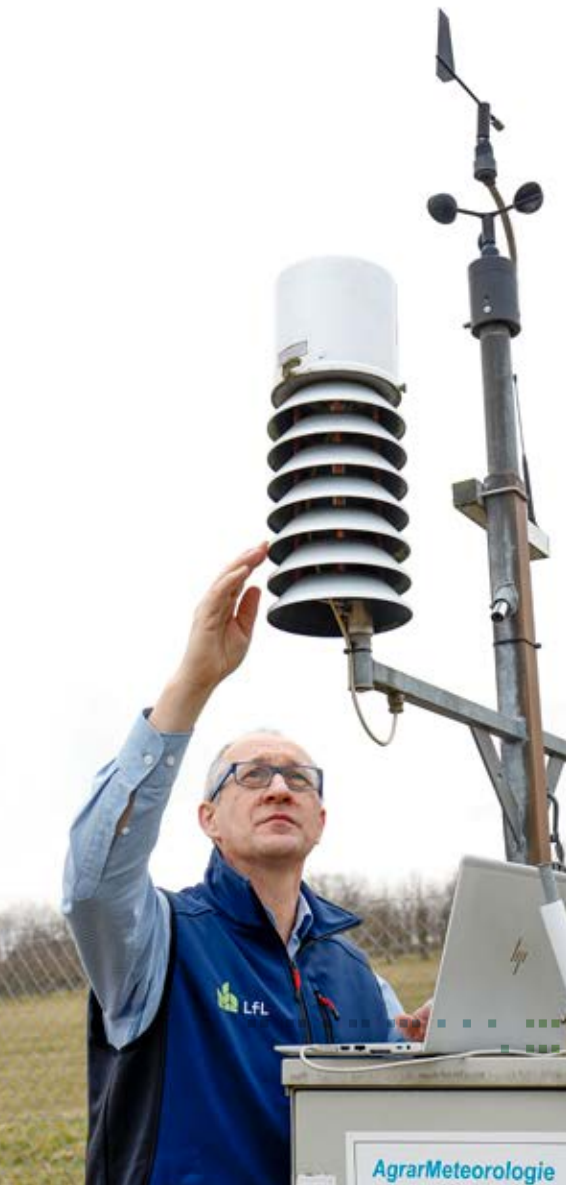
Messung aller wichtigen Wetterparameter rund um die Uhr: eine der bayernweit 140 agrarmeteorologische Messstationen der LfL
