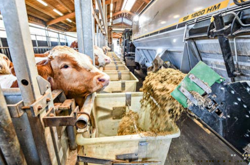
Intelligente Technik in der Bullenmast: Nährstoffangepasste Fütterung über den vollautomatischen Futtermischwagen in Grub
