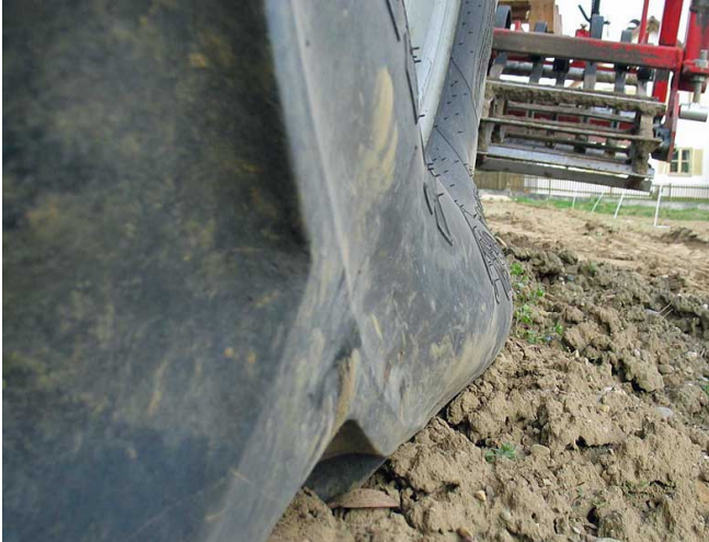
Bild 3: Auf Feldfahrt angepasster Reifeninnendruck: vergrößerte Aufstandsfläche – niedriger Kontaktflächendruck (© LfL, Bild: ILT1a)
