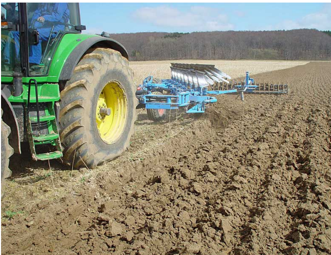
Bild 4: Bodenschonung durch großvolumige Bereifung, angepassten Reifeninnendruck, Fahren auf dem noch nicht gelockerten, tragfähigen Boden und aufgesatteltem Drehpflug (© Lemken)
