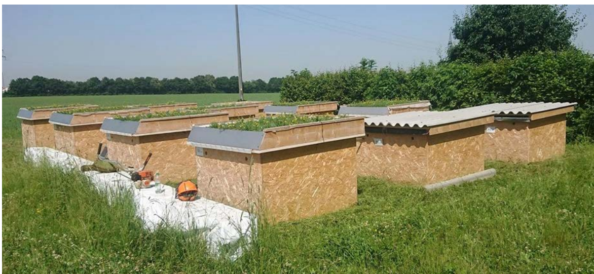
Versuchsdächer zur Untersuchung des Optimierungspotentials bei Gründächern
