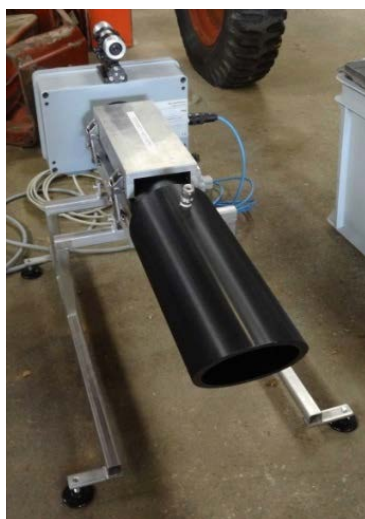
Transceiver des „OP-TDLS“ auf einem Tunnelstativ (links), Verlauf von Ammoniakkonzentrationen und Lufttemperatur im Tunnel bei drei aufeinanderfolgenden Testmessungen an einem Laufhof (rechts)
