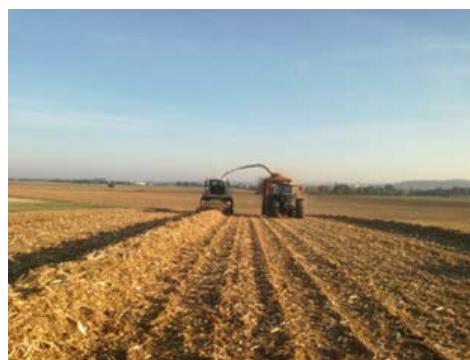
Schwaden (links) und Bergung von Körnermaisstroh mit der Häckselkette (rechts)
