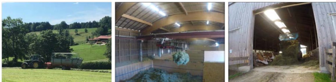
Einfahren des Heus mit Ladewagen (links), Umlagern zwischen Trocknungsboxen mit Kran (Mitte) und Heuvorlage am Futtertisch mit Ladewagen (rechts)
