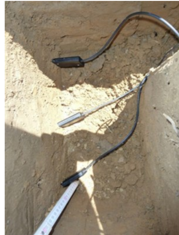
Sensoreinbau in 38 cm Tiefe
