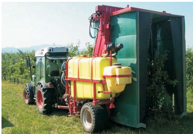
Tunnelspritzgerät im Obstbau zur Abtriftreduktion und Pflanzenschutzmitteleinsparung
