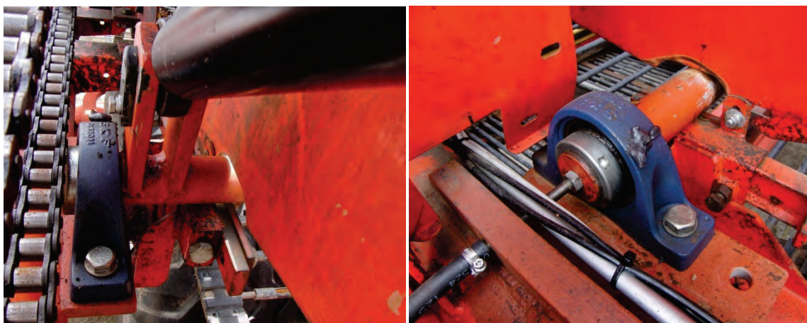
Abb. 30: Lagerung (links) linksseitig, (rechts) rechtsseitig von der Verstellachse im 3. Siebband
