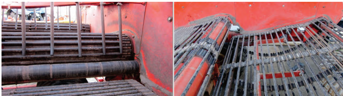
Abb. 13: :(links) ursprüngliche Übergabe, (rechts) nach Entfernen der Zupfwalze
