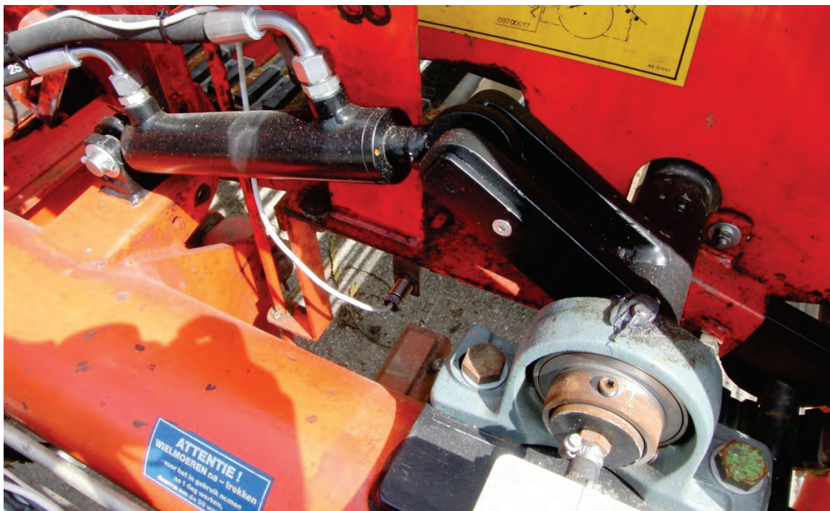
Abb. 18: Hydraulische Neigungswinkelverstellung im 2. Siebband
