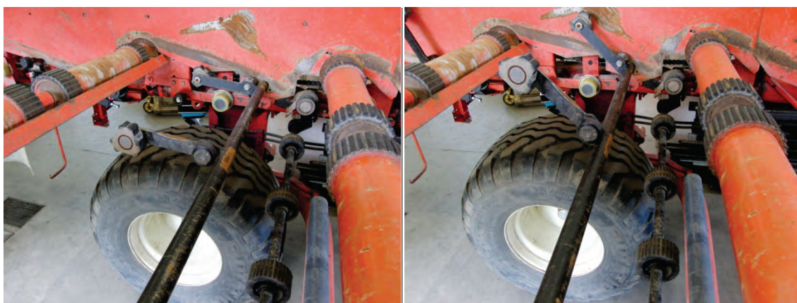
Abb. 17: (links) abgesenkte, (rechts) angestellte Verstellung im 2. Siebband ohne Band
