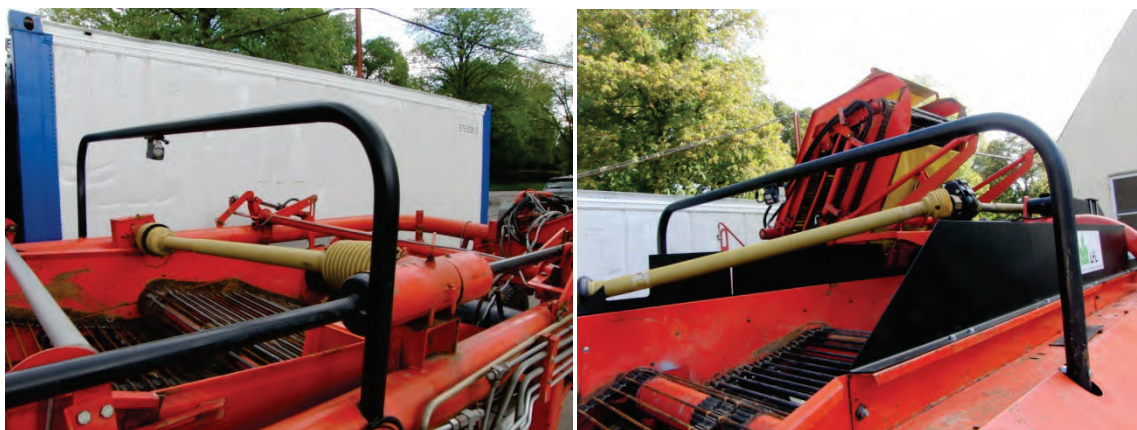
Abb. 49: Kamerahalterung (links) 1. Siebband, (rechts) 2. Siebband
