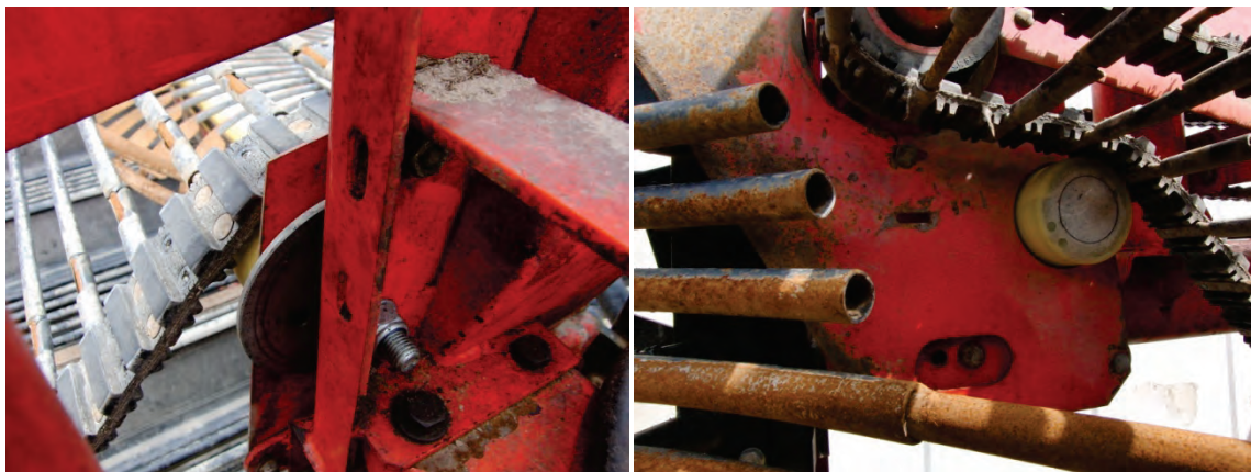
Abb. 32: Aufhängung der hinteren linksseitigen Führungsrolle
