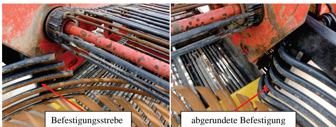
Abb. 38: Gleitrostbefestigung (links vor, rechts nach der Abgabeöffnung)
