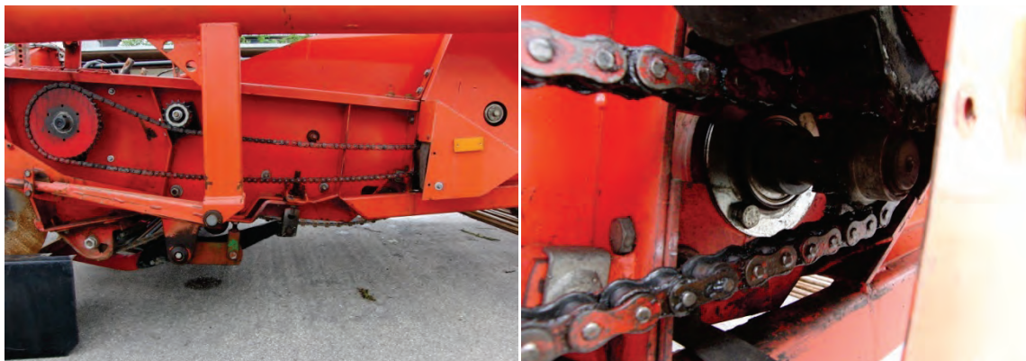
Abb. 8: Reißtrommelantrieb über Gliederkette, (rechts) Antriebsritzel
