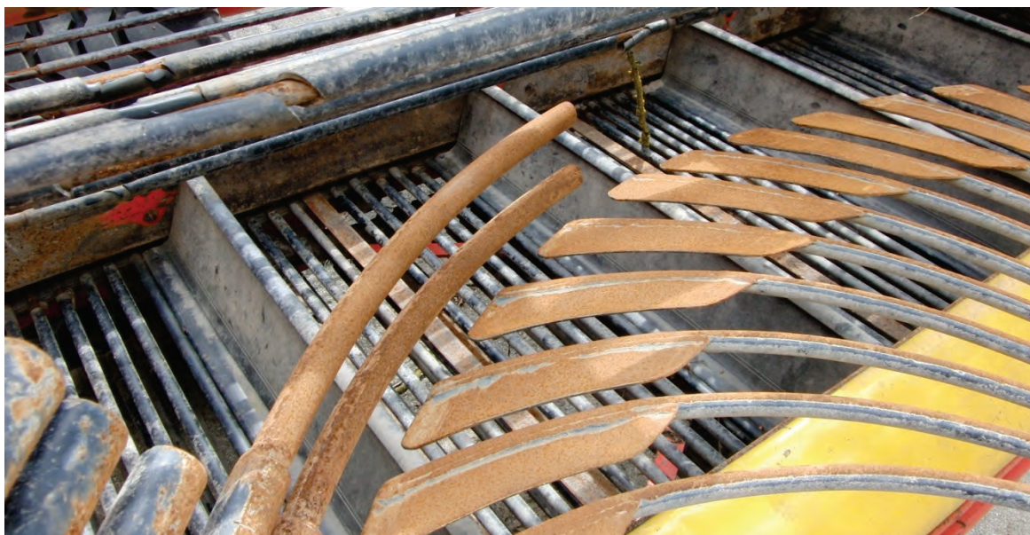
Abb. 44: Elevatorband mit bereits entnommenen Paddeln
