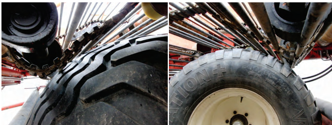
Abb. 25: Kollision des 2. Siebbandes bei eingeschlagenem Reifen und abgesenktem Hangausgleich
