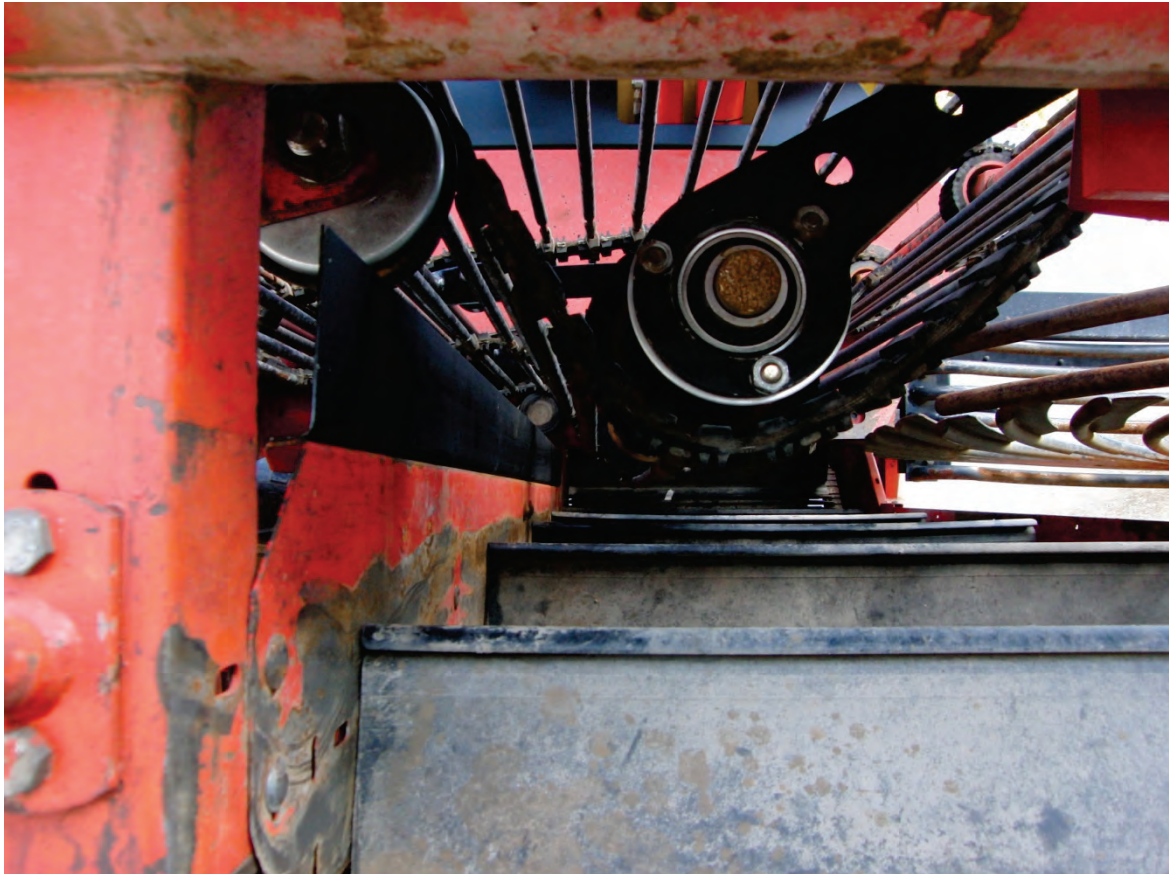
Abb. 45: Erhöhung der Seitenbegrenzung am Elevator
