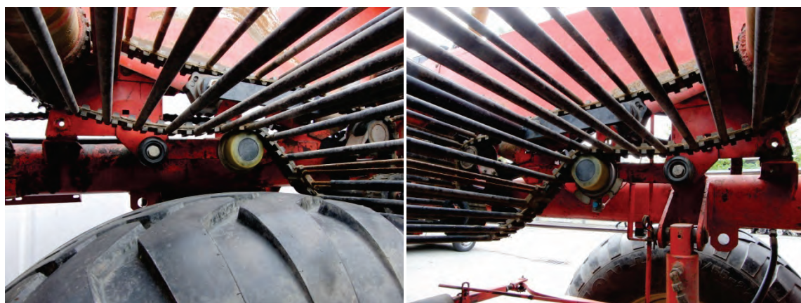
Abb. 22: Führungsrollen unter dem 2. Siebband (links) linksseitig, (rechts) rechtsseitig
