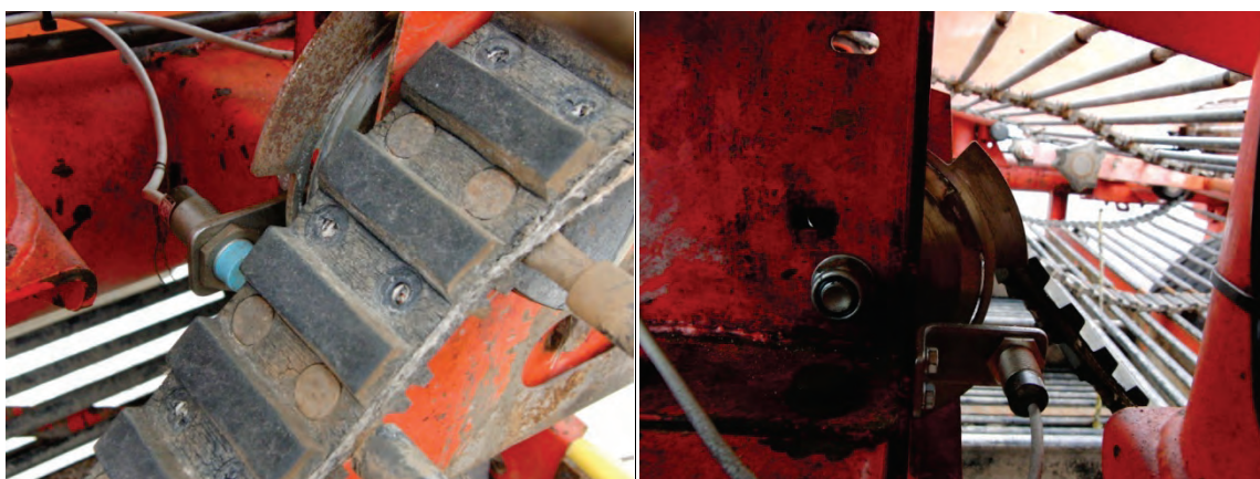
Abb. 53: Spezielle Führungsrolle mit Sensor zur Ermittlung der Bandgeschwindigkeit im dritten Siebband
