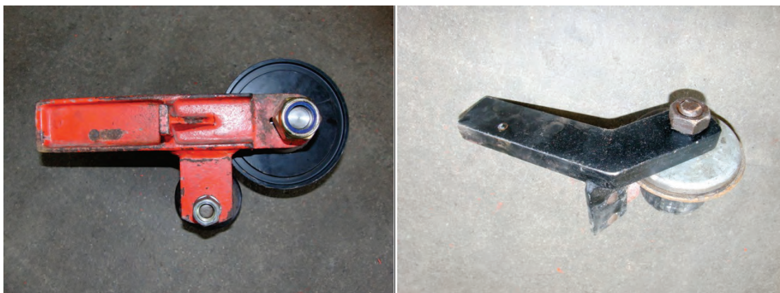
Abb. 21: (links) original, (rechts) abgewinkelter Umlenkrollenhalter im 2. Siebband
