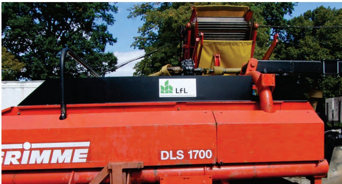
Abb. 57: Erhöhung der Seitenkanalwand
