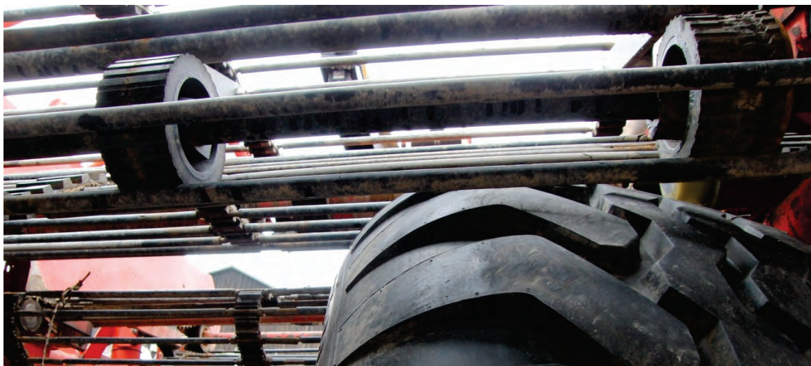
Abb. 26: Positionierung der Rollen im Kettenspanner des 2. Siebbandes
