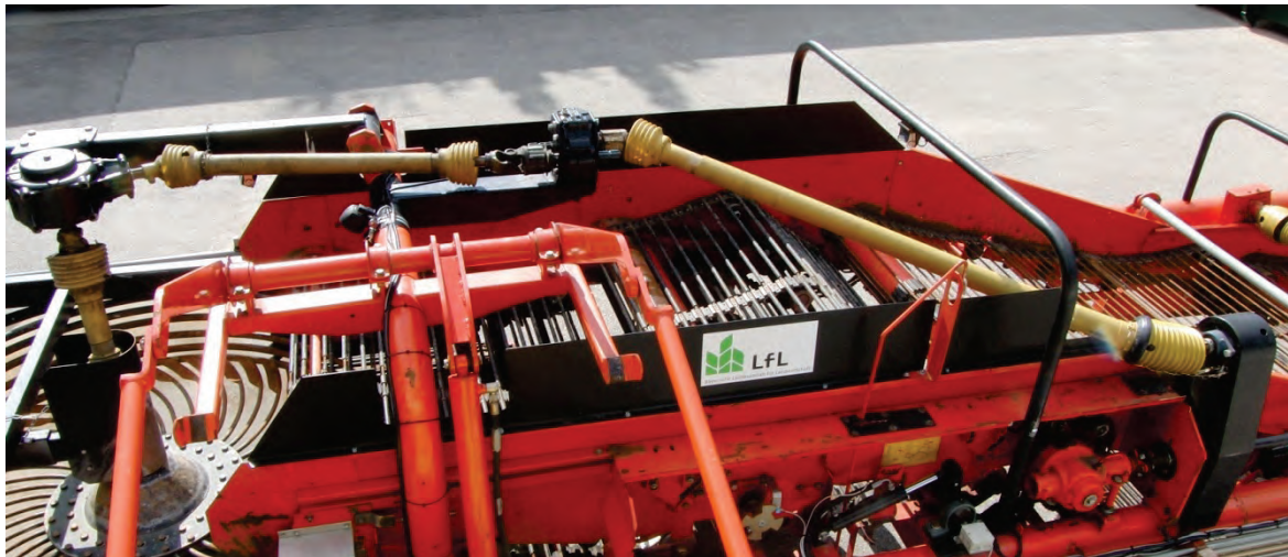
Abb. 40: Antriebsstrang des Siebsterns mit Stufen und Winkelgetriebe
