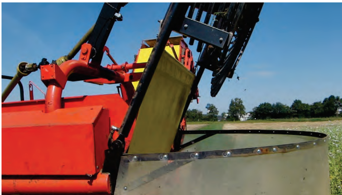
Abb. 36: Ausgehobener Siebstern mit Leitsegel
