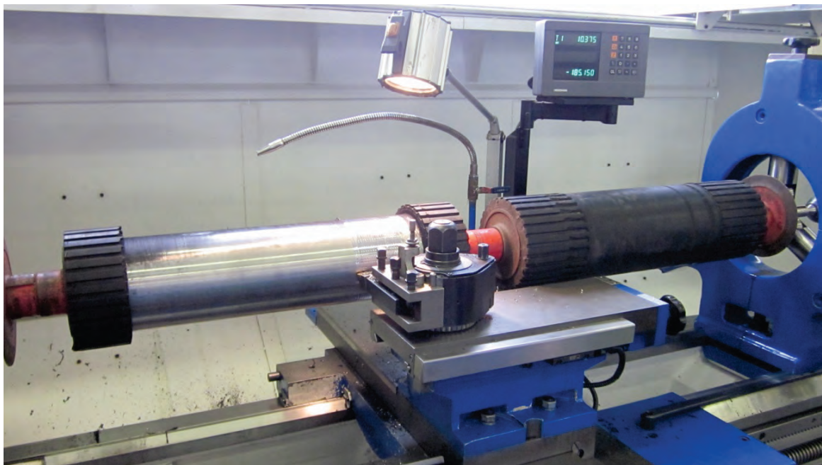
Abb. 15: Abdrehen einer geschlossenen Antriebstrommel
