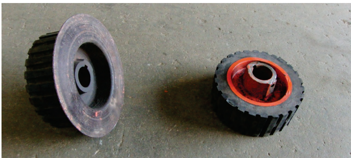
Abb. 27: (links) original, (rechts) abgedrehte Antriebsrolle des Feinkrautelevators
