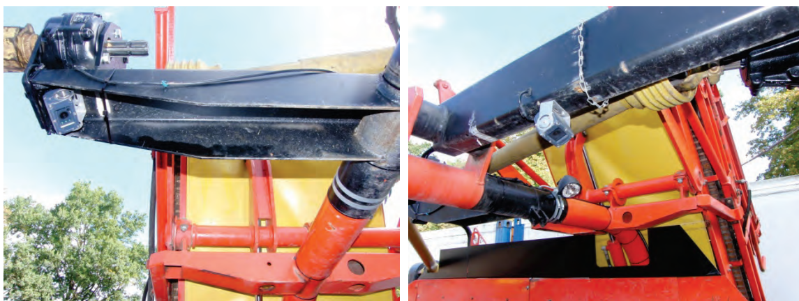
Abb. 50: Kamerabefestigung über dem 3. Siebband (links) und dem Siebstern (rechts)
