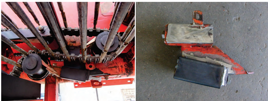
Abb. 33: Halterung für die vorderen Führungsrollen; (links) nach Montage, (rechts) bei der Fertigung
