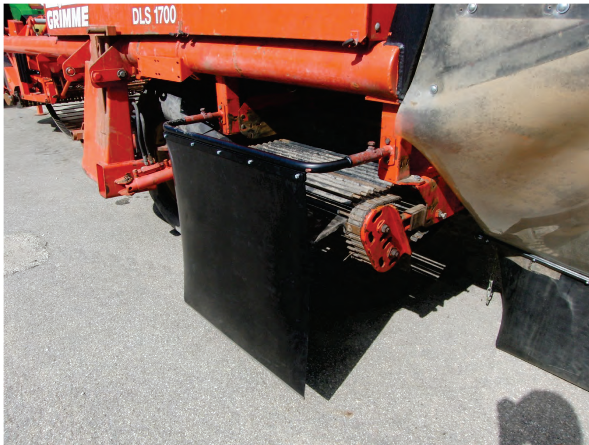
Abb. 46: Ablagetuch am Elevatorschutzbügel
