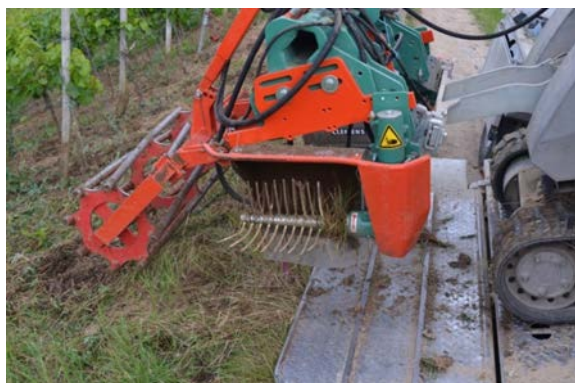
Abb. 2: Mähbürste MULIT-CLEAN der Firma Clemens (Wittlich, Mosel)
