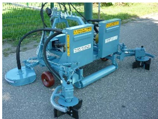
Abb. 3: Unterstockmulcher der Firma Siegwald (Bildquelle: Firma Siegwald Auggen, Baden).
