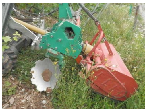
Abb. 4: Scheibenpflug in Kombination mit Mulchgerät
