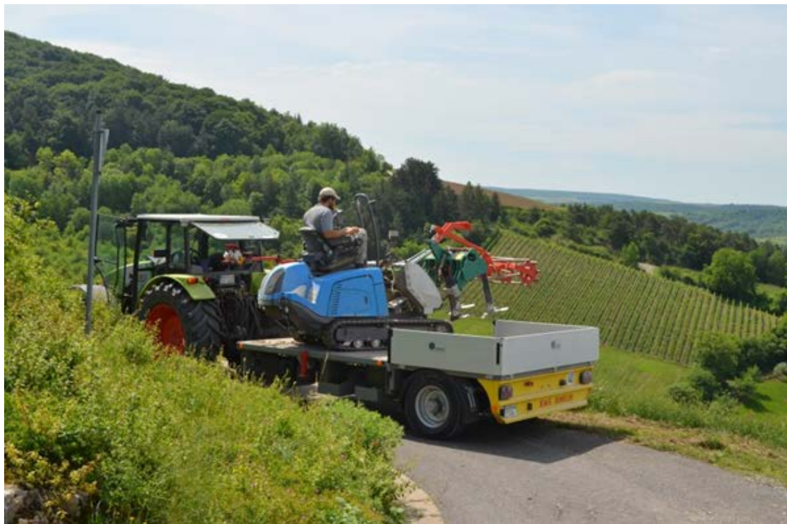
Abb. 1: Raupenmechanisierungssystem (RMS) der Firma Geier auf Transportfahrzeug
