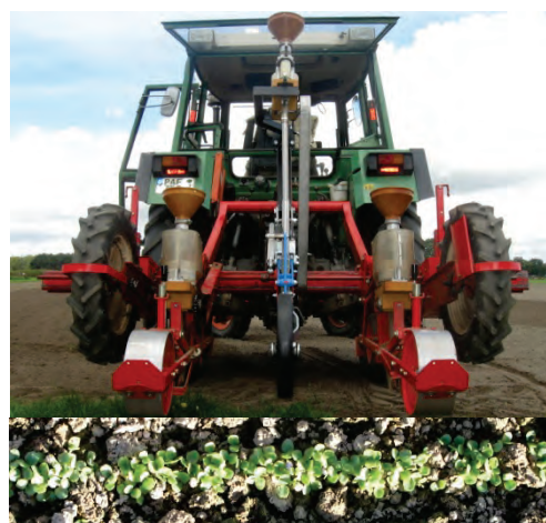
Digitaler Prototyp des Säaggregats (links); Vergleichstest des Säaggregates mit der herkömmlichen Technik (rechts oben); Testergebnisse (rechts unten)
