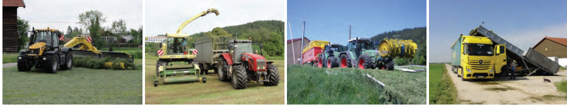
Einsatz verschiedener Verfahrensketten/-techniken auf den Pilotbetrieben – Bandschwader, Häckselkette, Ladewagenkette und Überladeverfahren (v.l.n.r.)
