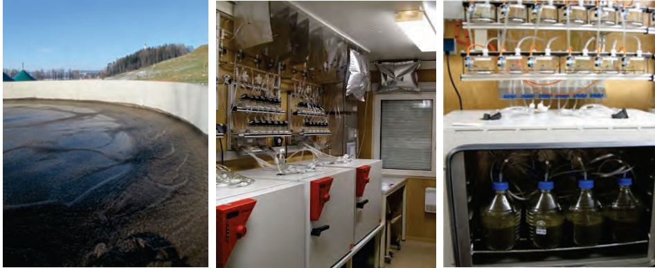
Projekthintergrund in Bildern (von links): Nicht abgedecktes Gärrestlager; Versuchsaufbau am ILT mit Thermoschränken; Blick in einen Thermoschrank mit Klein-Batchfermentern
