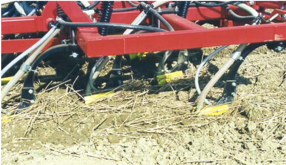
Abb.: Grubberschar mit Zuleitungen für Saatgut und Dünger
