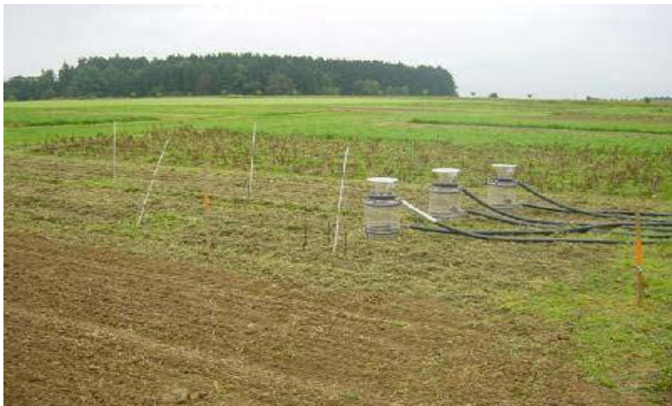
Abb.: Fruchtfolgeversuch: Messung von Stickstoffemissionen
