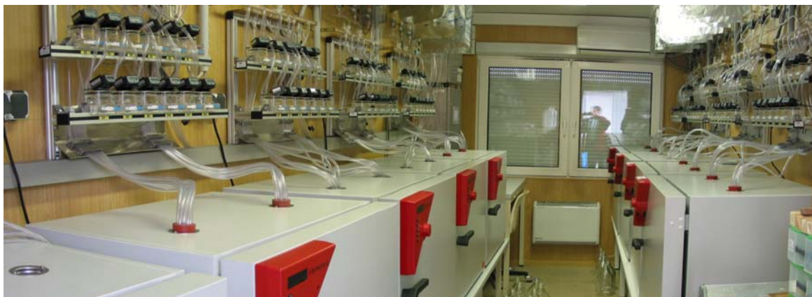
Automatisierte Laboranlage (Batch-test) zur Bestimmung des Methanertragspotenzials von Substraten in Biogasfermentern
