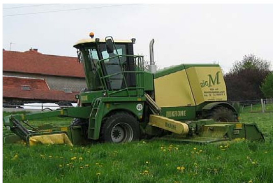
Selbstfahrender Großflächenmäher „Big M I“ der Firma Krone
