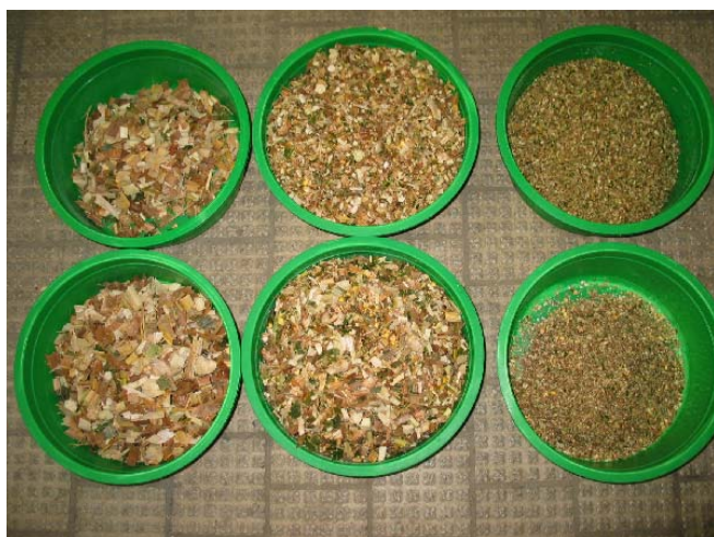
Siebfractionen von Maissilage mit 5 mm (oben) bzw. 19 mm (unten) Häcksellänge
