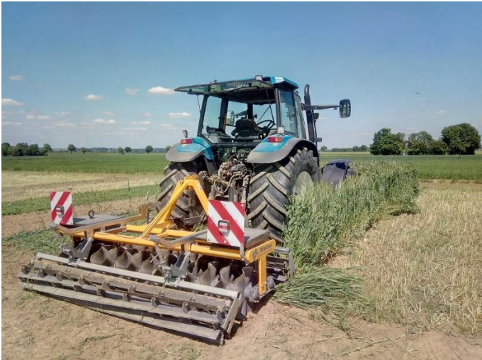
Einsatz der Messerwalze
