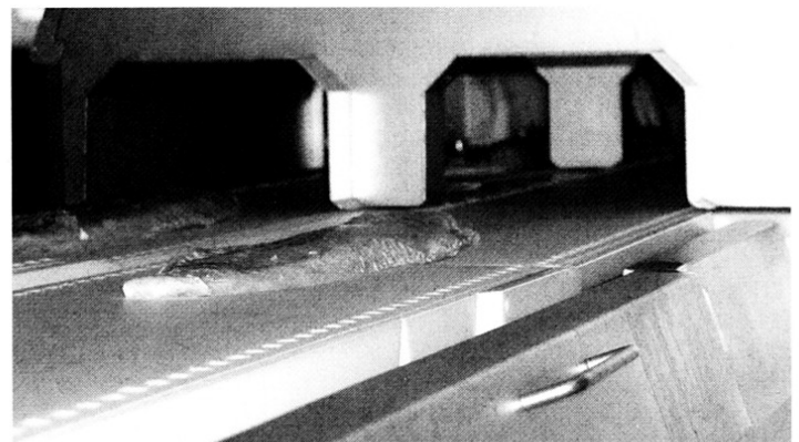
Mit einem Filetscanner werden bei der Deutschen See Dorschfilets eingescannt und vermessen. Im Anschluss werden daraus Teilstücke von exakt gleichem Gewicht geschnitten.
