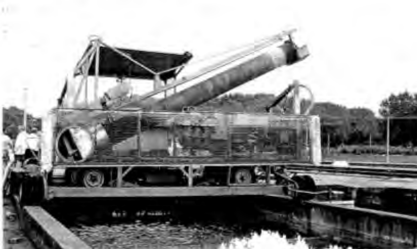
Hebe- und Sortieranlage, Forellenzucht Murgat
