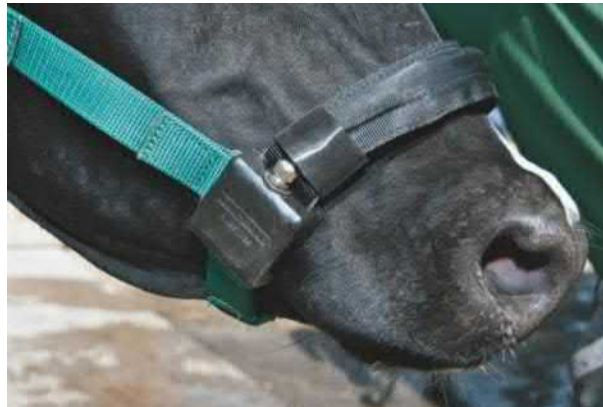
Abbildung 2: Sitz des Druckschlauches an der Nase bei angelegtem RW-Messhalter (Quelle: ITIN+HOCH)
