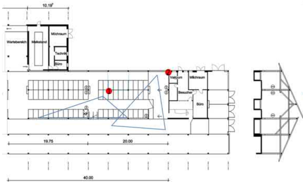
Abb. 19: Anordnung der Videokameras (rot) und deren Erfassungsfeld (blau) in der AMS-Gruppe, Milchviehstall Grub
