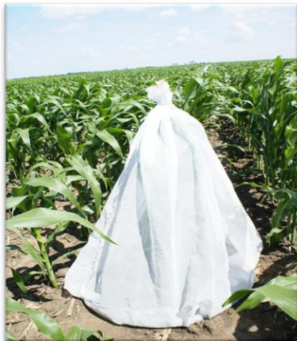
Schlupfkäfig mit Metallring, Höhe 1,40 m, Grundfläche 1 m 2 . Ma- schenweite der Gaze 0,2 mm)
