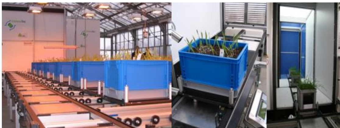
Abbildung 1 Die Moving fields Anlage der LfL. Diese Anlage ermöglicht es, Pflanzenbestände durch ein Gewächshaus fahren zu lassen. Pflege (Bewässerung, Wiegung, Düngung) und Phänotypisierung (Bilddaufnahme) können dadurch vollautomatisch und äußerst exakt geschehen.
