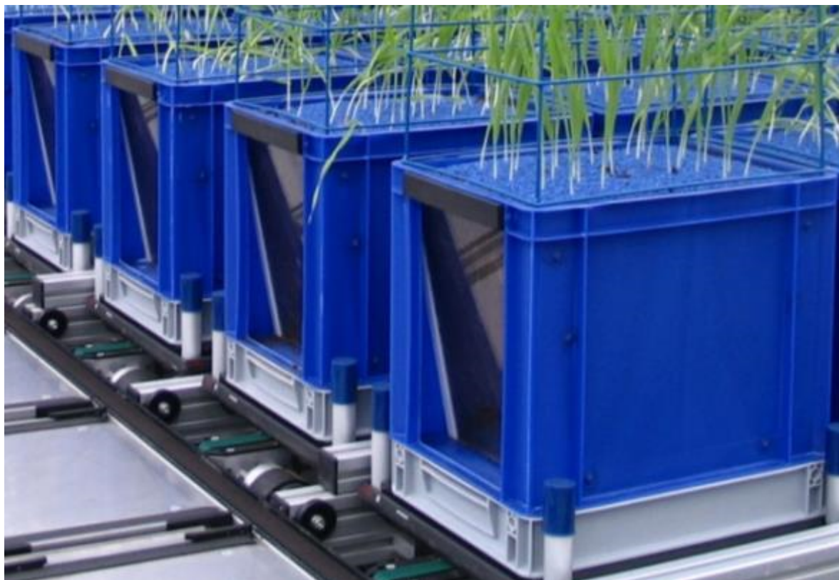
Abbildung 2 Die an der Moving Fields Anlage eingesetzten Pflanzenbehälter. Um Bilder vom Wurzelwachstum zu ermöglichen, werden seit Sommer 2014 als Pflanzengefäße blaue Eurobehälter in der Abmessung 40 * 30 * 32 cm eingesetzt, die an zwei gegenüberliegenden Seiten mit Scheiben aus Plexiglas versehen sind.
