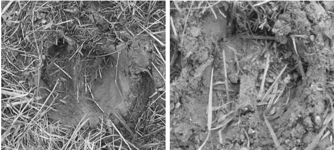
Abb. 3: Abdruck einer echten (links) und der mechanischen Klaue (rechts) in feuchtem Boden.
