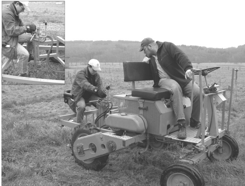
Abb. 1: Versuchsgeräteträger „Hege 75“ mit angebauter hydraulischer Rinderklaue.
