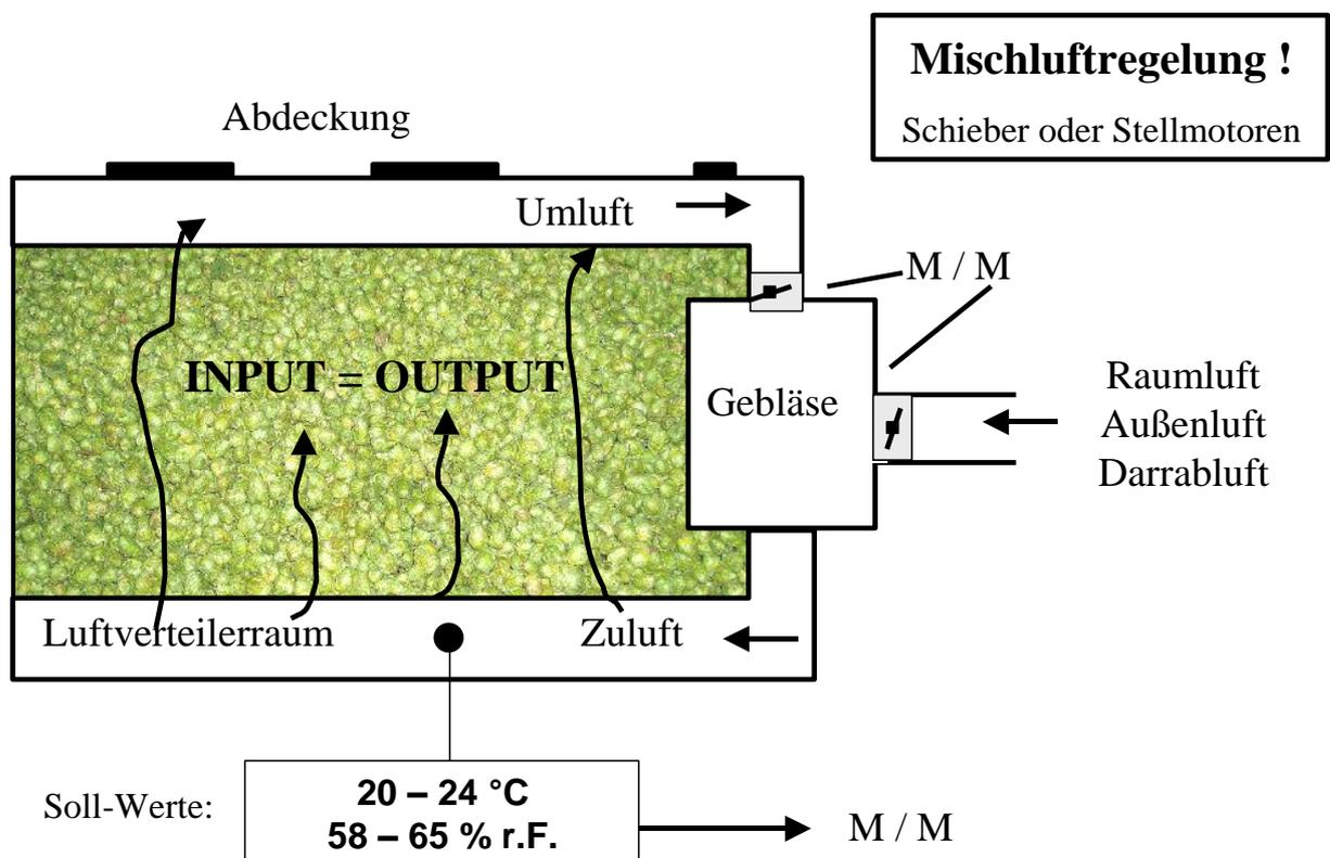
Abbildung: Schema der Nachbehandlung von Hopfen in Konditionierungskammern
