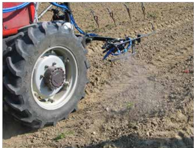
Sensorgesteuerte Flachstrahldüsen zur Reihenbehandlung
