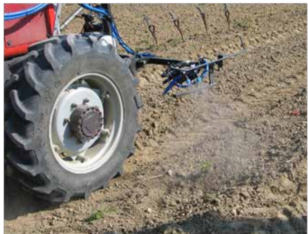
Sensorgesteuerte Flachstrahldüsen zur Reihenbehandlung
