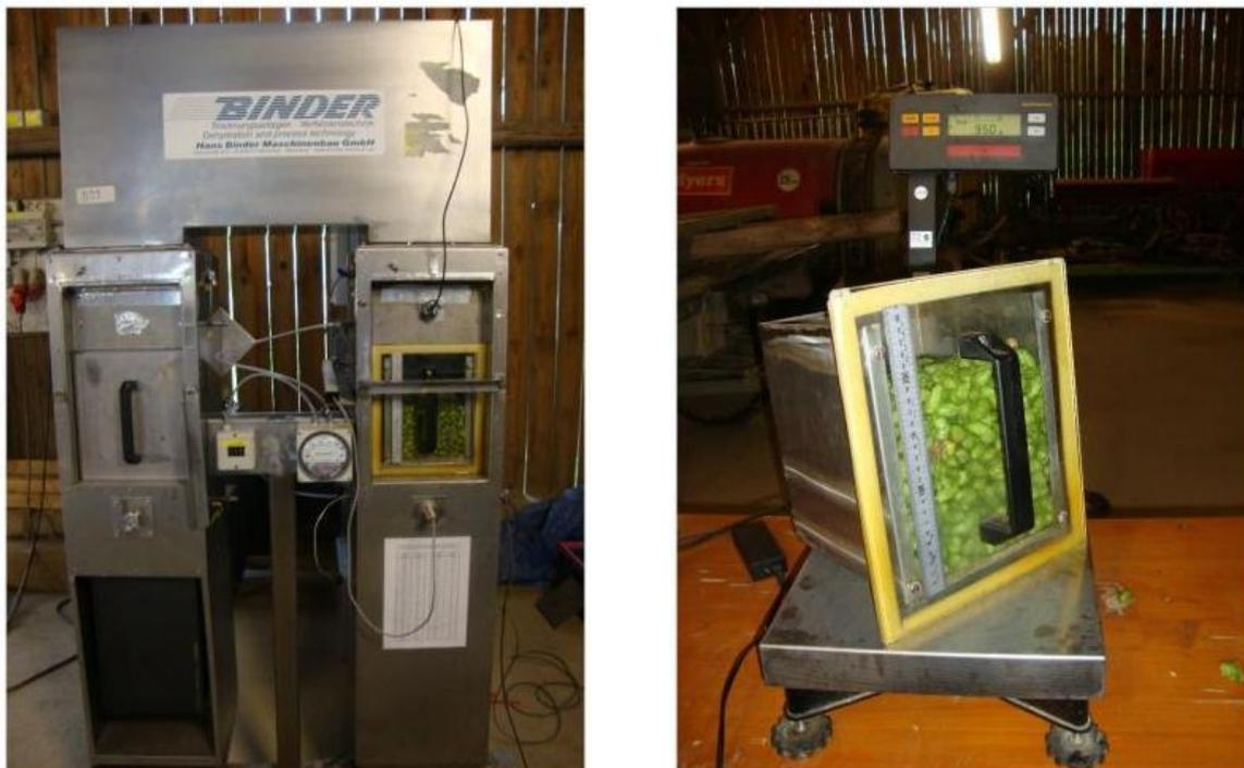
Abb. 5.3: Kleintrocknungsversuchsanlage (links) und Wiegevorrichtung (rechts) zur Ermittlung des Wasserentzuges während der Trocknung
