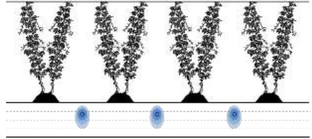
Abb.: Tropfschlauch unterirdisch, in der Fahrgassenmitte
