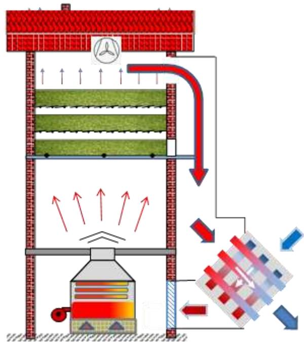
Abb.: Prinzip einer Wärmerückgewinnung (schematisch)
