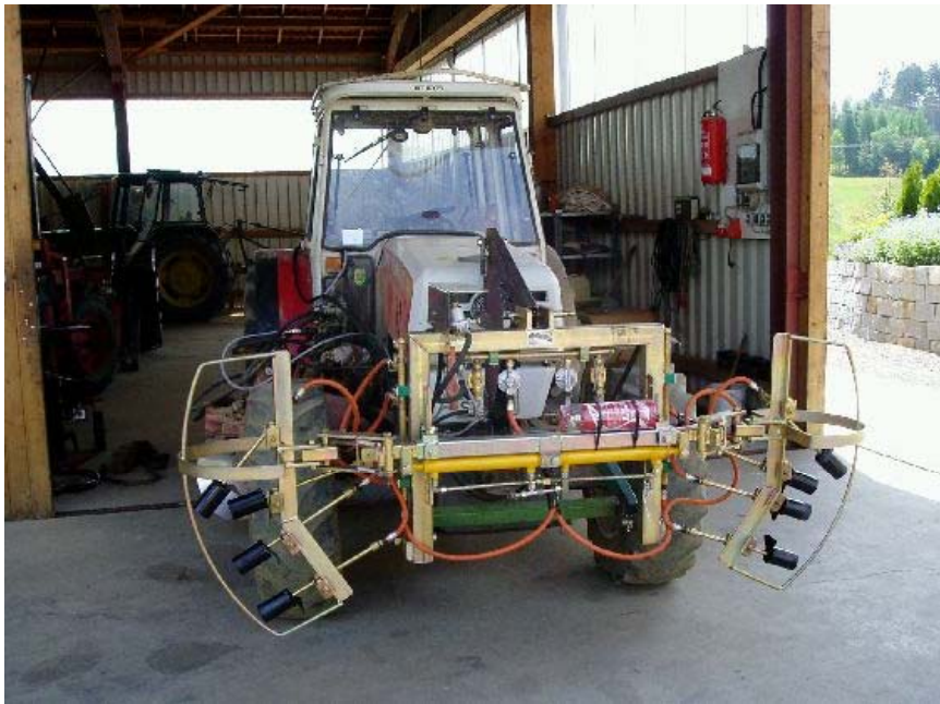
Abbildung 5.3: Brenner zum Abflammen im Frontanbau
