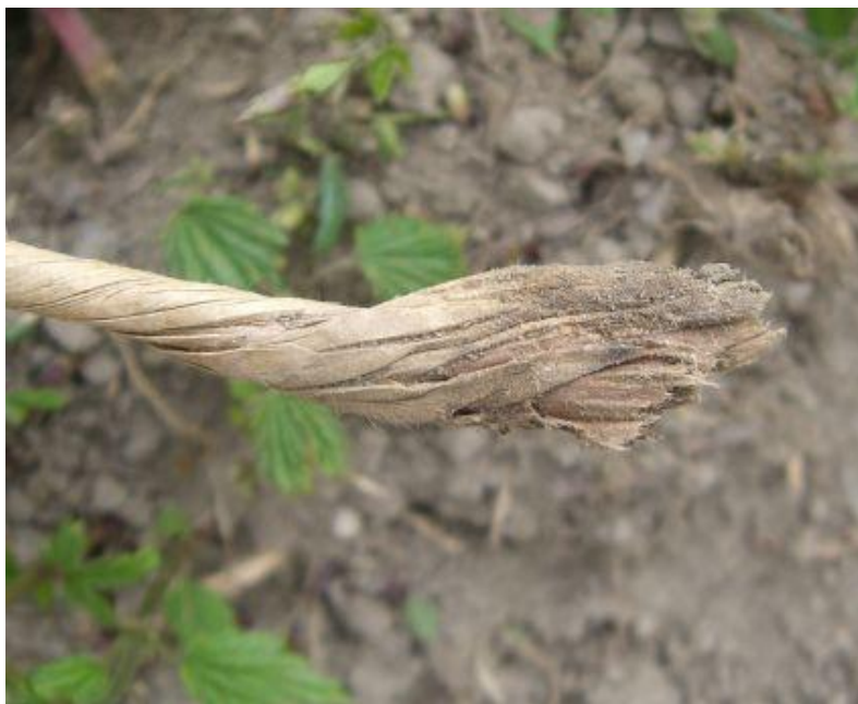
Abb. 5.5: Verrottete Papierschnur am Übergang Boden - Luft
