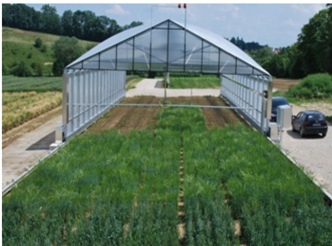
Abb. 11: Rainout-Shelter der LfL. Ein ausgewähltes Gerstensortiment von hoher genetischer Diversität wird unter „Feldbedingungen“ auf ihre Reaktion auf Trockenstress geprüft
