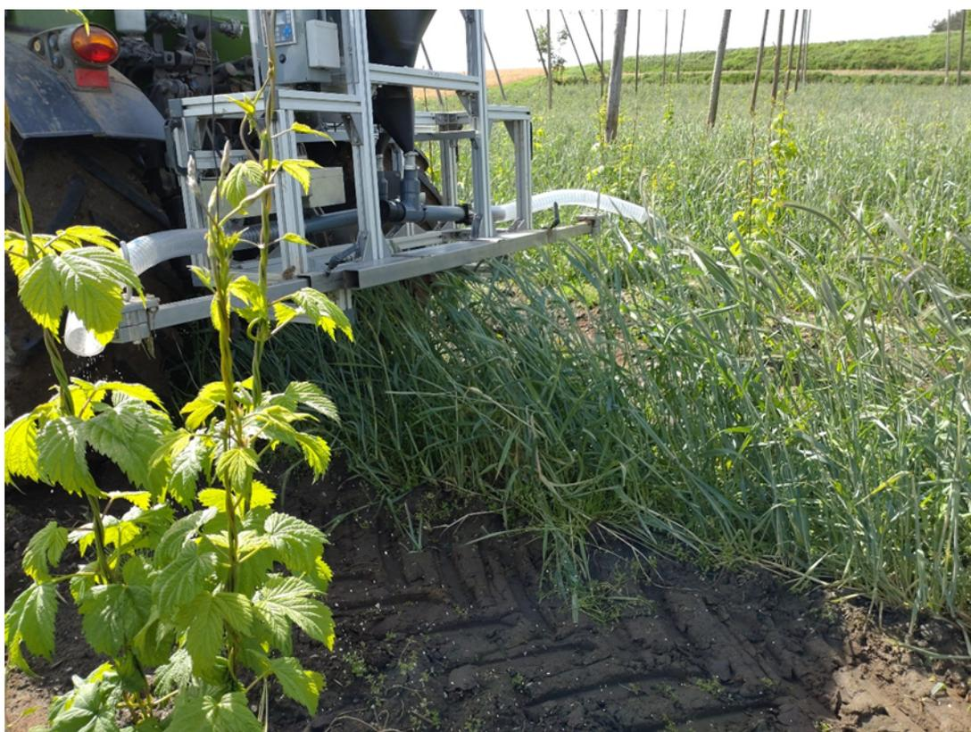
*Abb. 85: Mit Sägemehl als Trägersubstanz werden die Raubmilben bei der technischen Applikation sanft an die jungen Hopfenreben geblasen*
