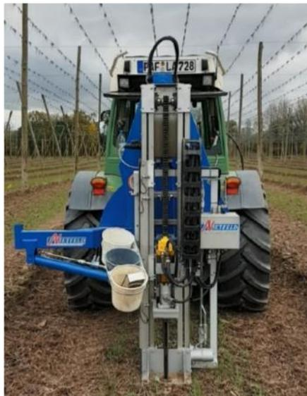
Abb. 12: Bodenprobenahmegerät
