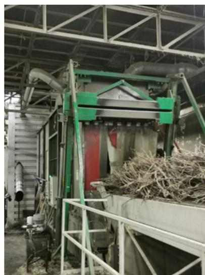
*Abb. 19: Dosierung des Versuchsmaterials in den Entholzungsprozess der Firma HempFlax Group B.V. in Oude Pekela (NL)*
