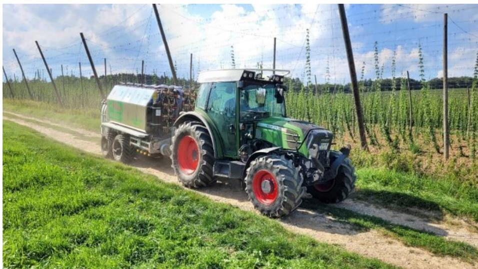
Abb. 48: Mehrkammernversuchsspritze der Amtlichen Mittelprüfung
