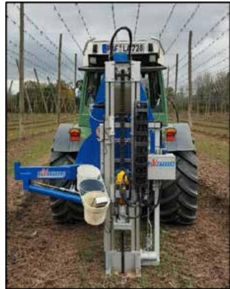
Abb. 4.5:  $N_{\min}$ -Bodenprobenehmer
