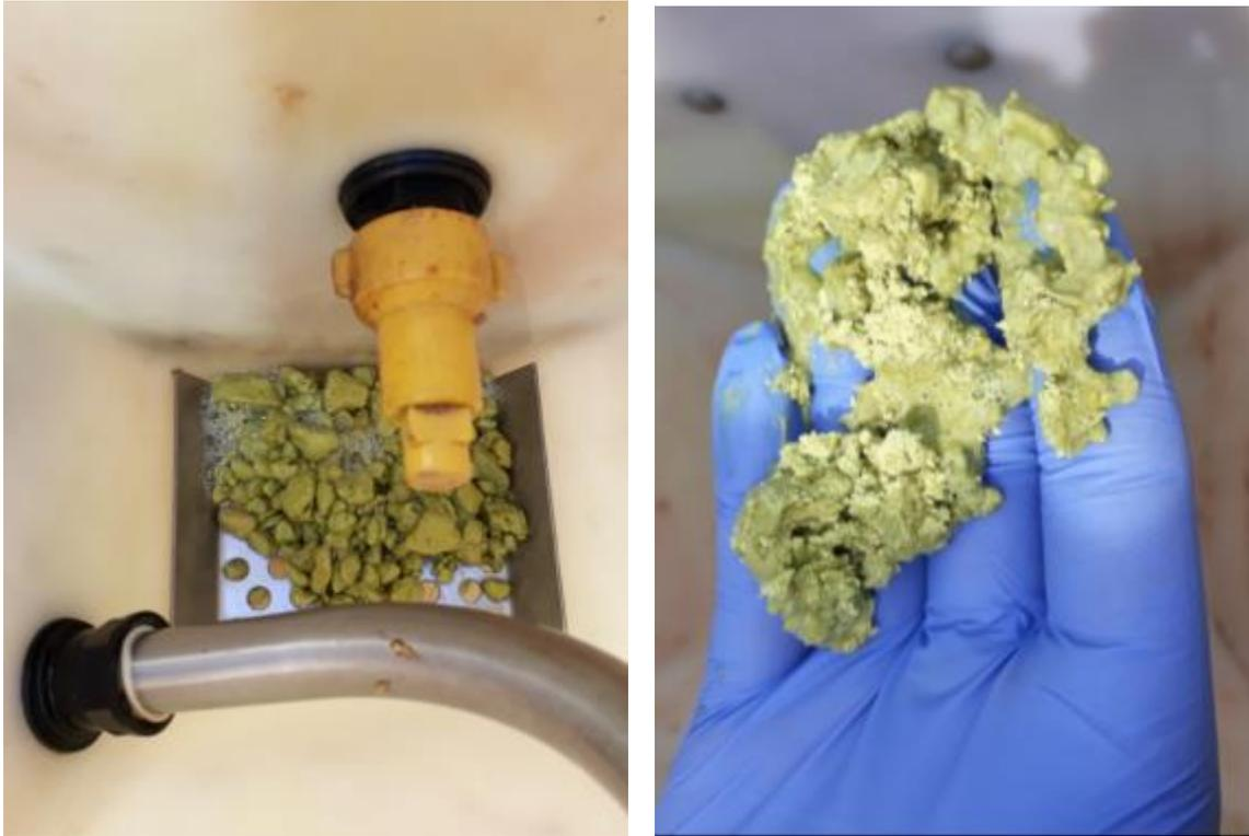
Abb. 8.6: In der Einspülschleuse der Hopfenspritze führte das direkte Befüllen mit Hop-Caps ohne vorheriges Anrühren in Wasser weiterhin zu Klumpenbildung.
