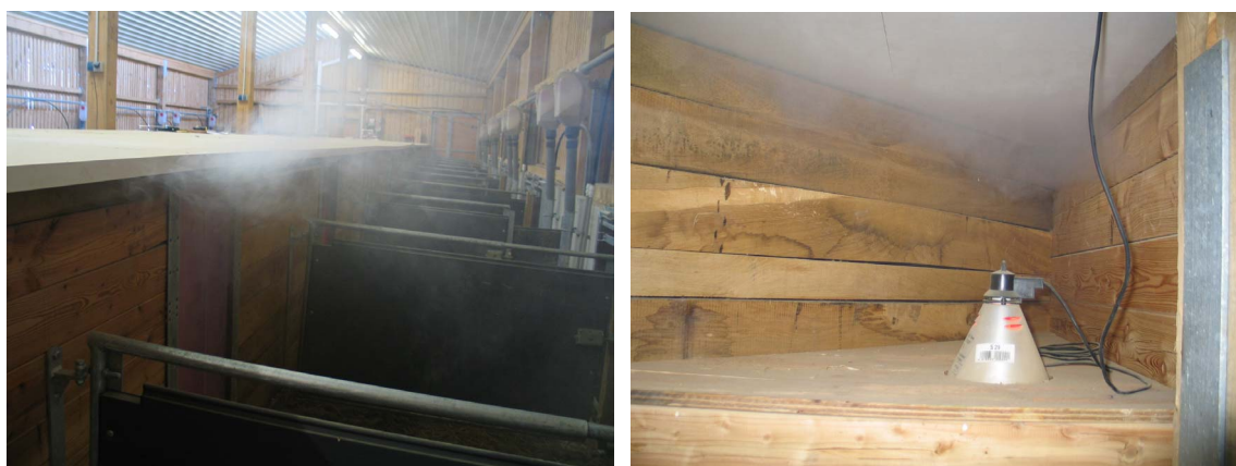
Abb. 27: Nebeltest: Luftströmungen an der Liegebereichsabdeckung
