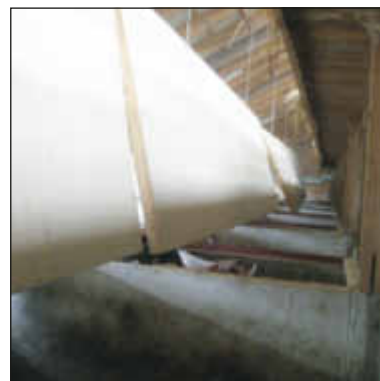
Die Deckel der Liegekisten werden automatisch beim Entmistungsvorgang angehoben. Eingestreut wird von einer Strohbühne aus.
