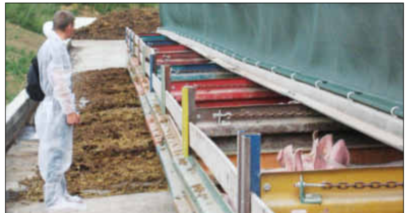
Die ein- und ausfahrbaren Leitplanken als Auslaufabtrennung des Mastbetriebs Krämer sind eine besonders ausgeklügelte Konstruktion.
