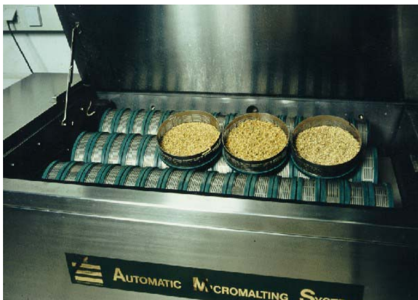
Abb. 12: Kleinmälzungsautomat zur Gewinnung von Malz für die Bestimmung der Brauqualität
