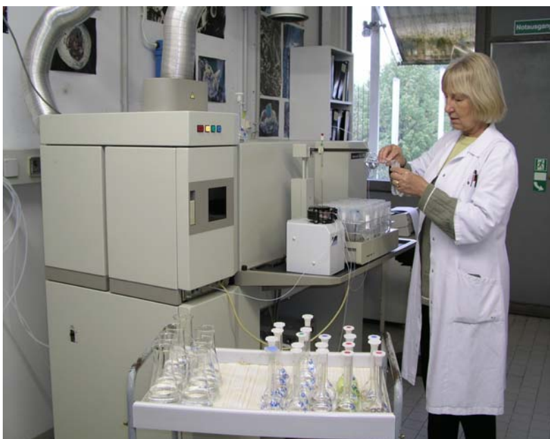
Abb. 2: Atomspektroskopische Elementmessung für Düngemitteluntersuchungen
