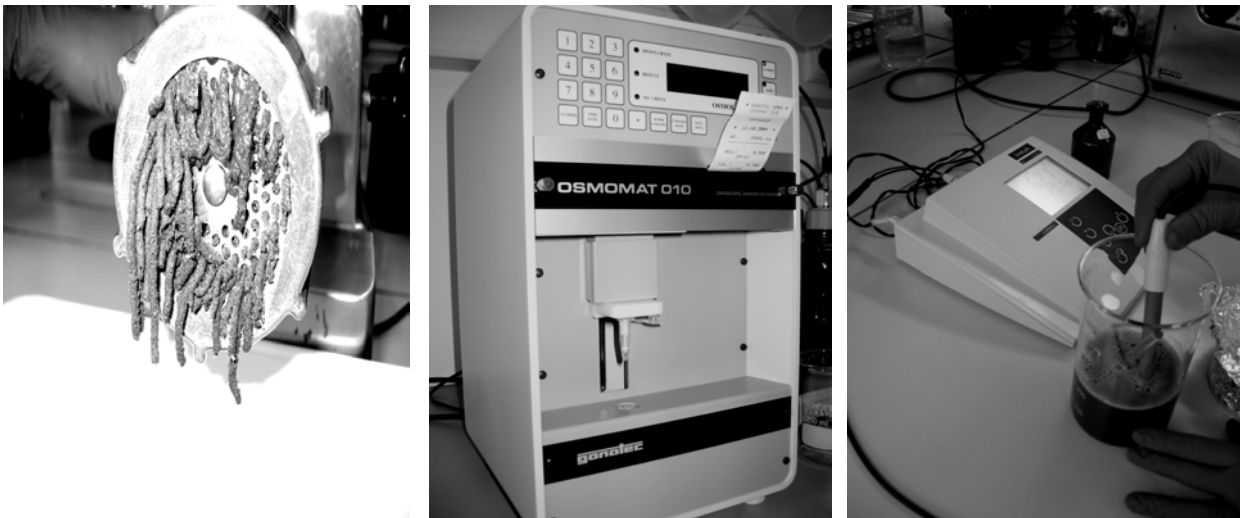
Abb 18.: Bestimmung der Siliereigenschaften von Pflanzenmaterial und Wirksamkeit biologischer Silierzusätze nach Methode Zierenberg: Vermusen und Herstellung des Presssaftes (links), Bestimmung der Osmolalität (Mitte) und des pH-Wertes (rechts)
