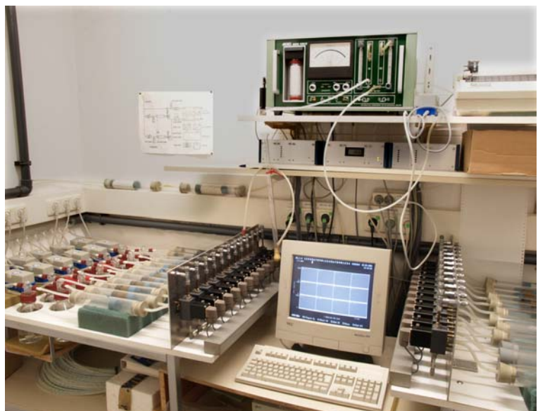
Abb. 4: SIR-Anlage zur Messung der mikrobiellen Aktivität von Materialien
