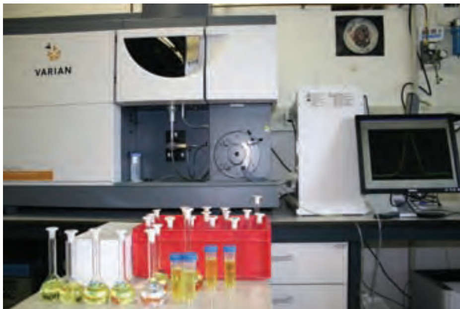
Königswasseraufschlüsse von Düngemitteln zur Multielementanalyse am ICP-OES
