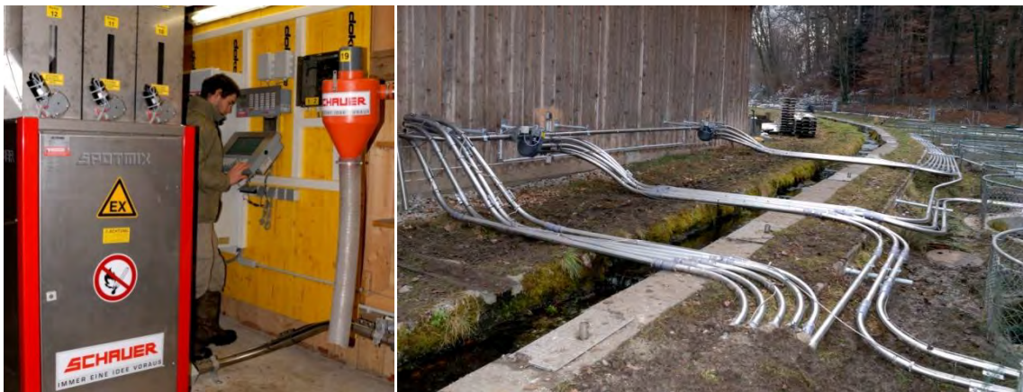
Moderne Fütterungstechnik: Fütterungszentrale (links) und Futterrohre (rechts)
