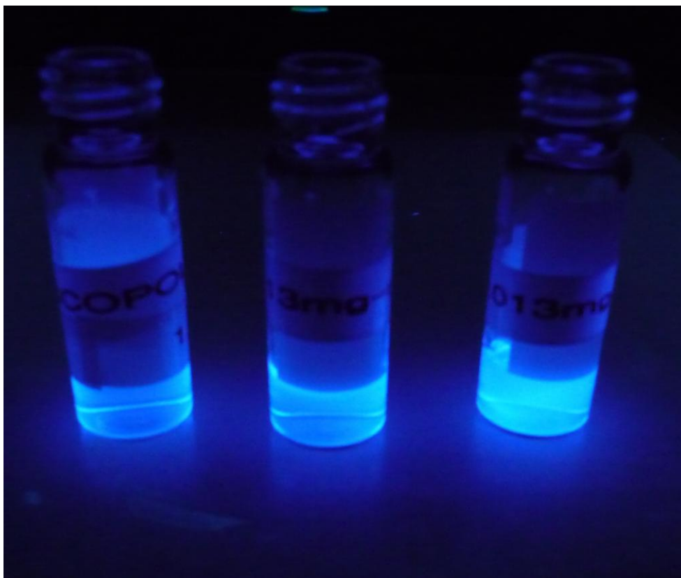
Abb. 20: Fluoreszenz von Scooletin-Standardlösungen unter UV-Licht (366 nm).
