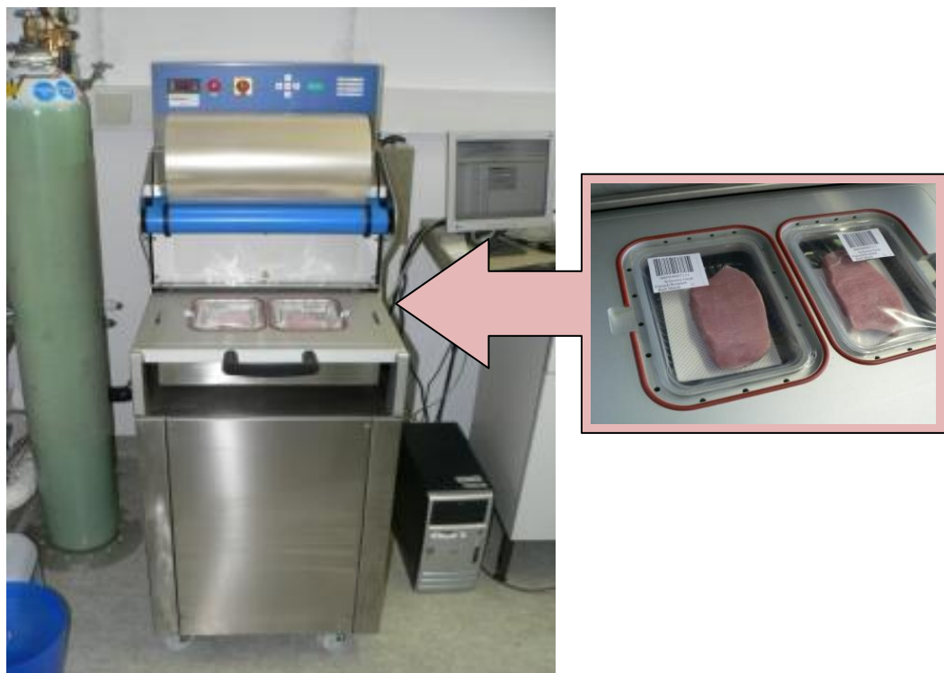
Abb.26: Bestimmung des Tropfsaftverlustes von Schweinefleisch unter Schutzgasatmosphäre
